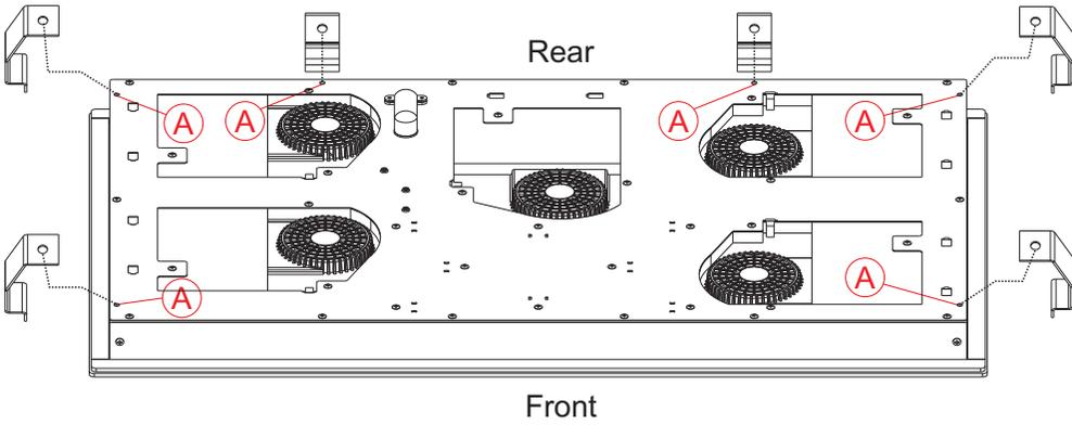
2. Aligner le trou de monta de l'espaceur avec le trou de montage de la position A
