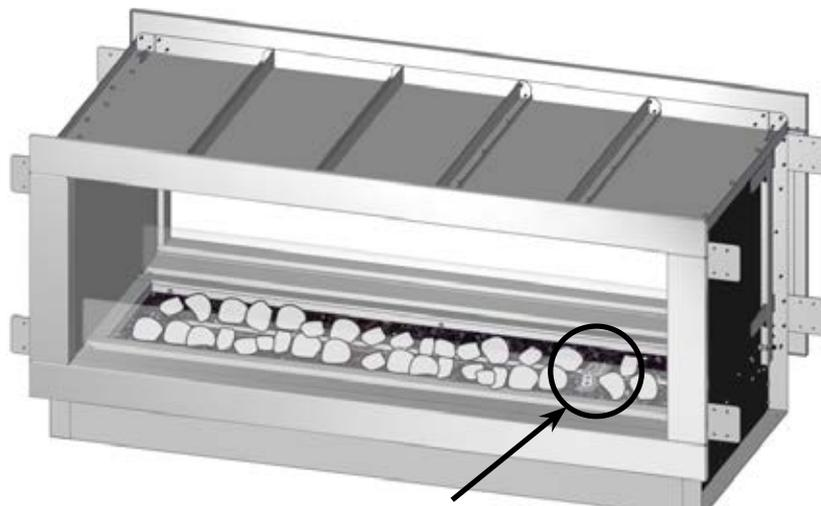
**ENSURE NO ROCK IS PLACED ON THE IGNITION PORTION OF THE BURNER, DIFFICULTIES IN LIGHTING MAY RESULT.**
