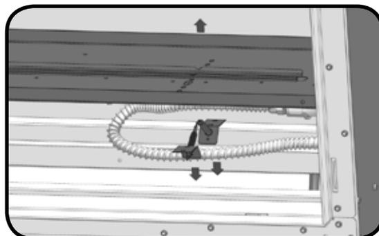
4. Débranchez le raccord flexible en acier inoxydable de l'injecteur à l'aide de deux (2) clés.
