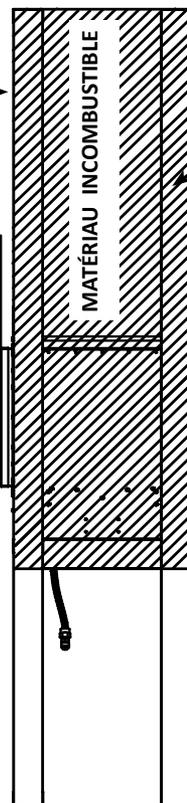
Les conduites de gaz et les fils électriques ressortent au bas de l'appareil, sur le côté droit.
