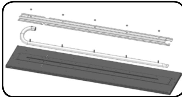
**Réinstallation:** Inversez la procédure pour réinstaller le brûleur en vous assurant que les trous sur le joint d'étanchéité entre le support du brûleur et le plateau à braises sont alignés. Vérifiez que l'injecteur entre dans le brûleur lors de l'installation. Remplacez les braises de verre et le déflecteur en verre avant. Lorsque l'appareil est remis en fonction, comparez l'apparence de la flamme du brûleur avec l'image ci-dessous.
