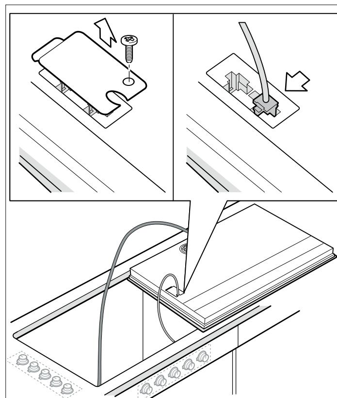
2. La placa debe asegurarse a la superficie de trabajo con los soportes de sujeción provistos, así que no se puede mover. Fije los soportes de la placa a la chapa envolvente con los tornillos sin apretarlos.
