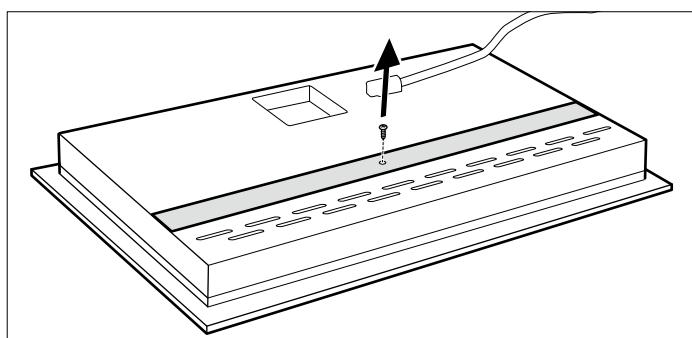
3. Posicione los soportes así que puede coloquar la placa en el hueco.
