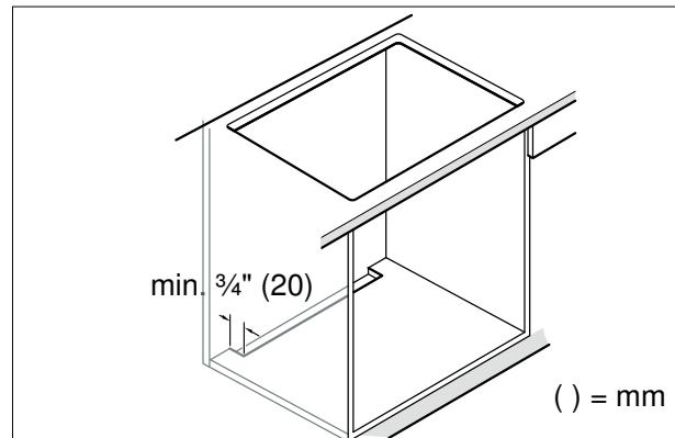
**Nota:** Si el aparato electrodoméstico es instalada en una unidad de isla u otra instalación que no se describe aquí, deberá asegurarse de que la placa de cocción esté suficientemente ventilada.
