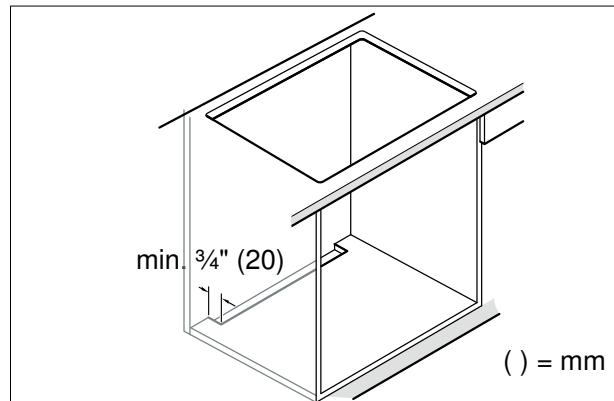
**Remarque :** Si l'appareil électroménager est installé dans un îlot ou un autre type d'installation qui n'est pas décrit dans le présent document, vous devez vous assurer que la table de cuisson est dotée d'une ventilation appropriée.
