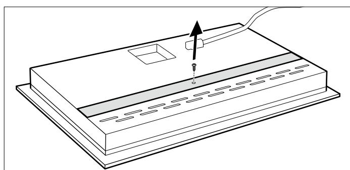
3. Déplacer les supports de fixation au mode que l'appareil puissent être placé dans la cavité.
