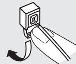
**3** Rilasciare la levetta. Tirare leggermente il cavo dell'altoparlante per controllare che sia saldamente collegato.
