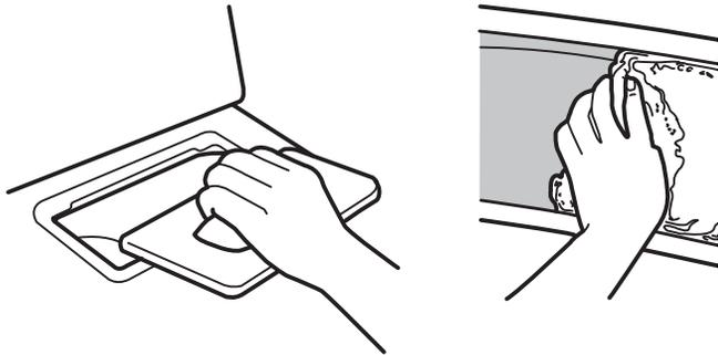
Nettoyer le filtre à charpie avant chaque charge. Enlever le filtre à charpie en le tirant tout droit vers le haut. Enlever la charpie du filtre en la roulant avec les doigts. Ne pas rincer ni laver le filtre pour enlever la charpie. Remettre le filtre à charpie fermement en place.
