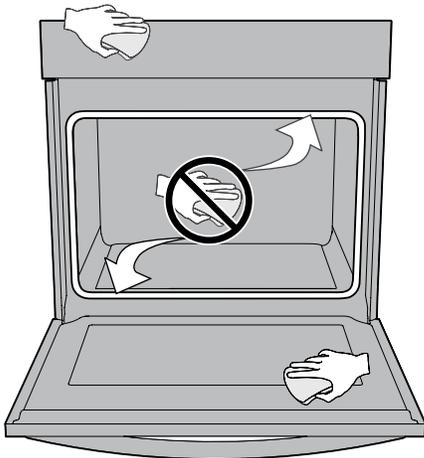
**Figure 14: Nettoyer le pourtour du joint de la porte du four**
