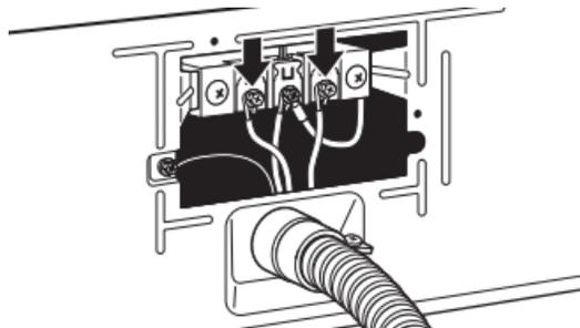
Placer les extrémités en crochet des conducteurs restants du câble pour raccordement direct sous les vis les plus à l'extérieur du bornier (crochets vers la droite). Rapprocher les extrémités du crochet et serrer la vis. Placer la languette du couvercle du bornier dans la fente du panneau arrière de la sècheuse. Fixer le couvercle avec la vie de retenue. Ensuite, aller à la section « Exigences concernant l'évacuation ».
