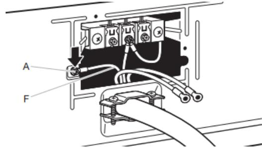
Connecter le conducteur (vert ou nu) de liaison à la terre (F) du câble d'alimentation sous la vis du conducteur de liaison à la terre externe (A). Serrer la vis.
