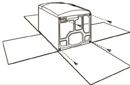
Afin d'éviter d'endommager le plancher, utiliser un grand morceau de carton plat extrait de la boîte d'emballage de la sécheuse et le placer sous toute la partie arrière de la sécheuse. Saisir fermement le corps de la sécheuse (et non pas le panneau de la console) puis reposer la sécheuse sur le carton avec précaution.
