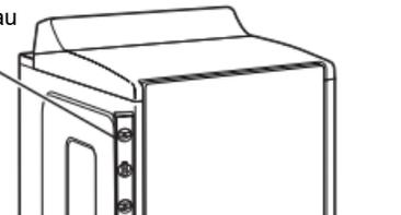
Vérifier l'aplomb de la sècheuse dans le sens transversal. Répéter l'opération dans le sens avant-arrière.
