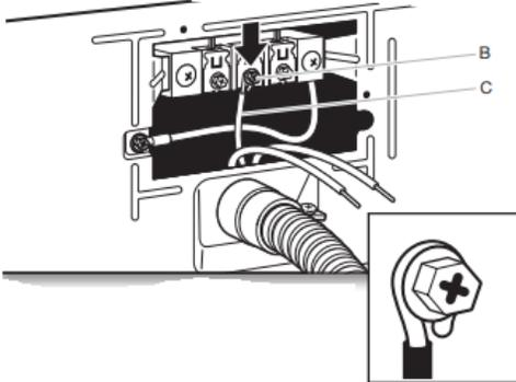
Placer le crochet d'extrémité du conducteur neutre (blanc ou central) (C) du câble pour raccordement direct sous la vis de la borne centrale (B). Rapprocher les extrémités du crochet. Serrer la vis.
