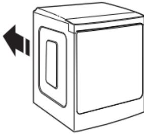
Placer la sècheuse à son emplacement final. Éviter d'écraser ou de déformer le conduit d'évacuation. Une fois la sècheuse en place, retirer les cornières et le carton sous la sècheuse.
