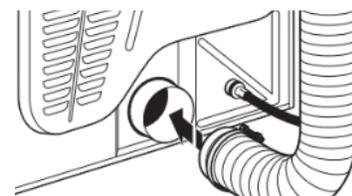
À l'aide d'une bride de fixation de 4 po (102 mm), relier le conduit d'évacuation à la bouche d'évacuation de la sècheuse. Si l'on réalise le raccordement au conduit d'évacuation existant, s'assurer que celui-ci est propre. Le conduit d'évacuation doit être fixé par-dessus la bouche d'évacuation de la sècheuse et à l'intérieur du clapet d'évacuation. S'assurer que le conduit d'évacuation est fixé au clapet d'évacuation à l'aide d'une bride de fixation de 4 po (102 mm).
