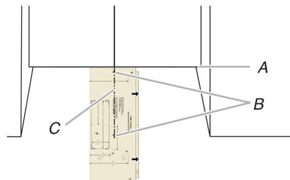
A. Bord inférieur de l'armoire supérieure et haut de la plaque de carton
