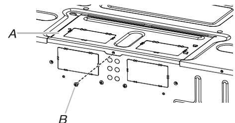
A. Plaque de support du clapet
