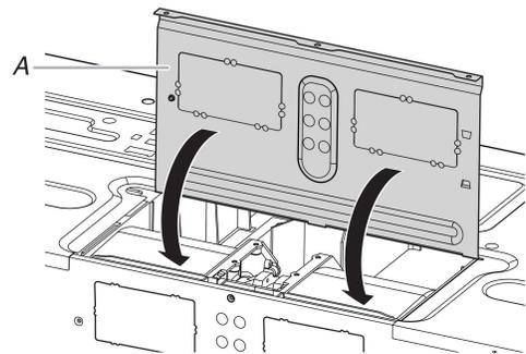
A. Plaque de support du clapet
