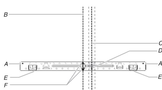
**REMARQUE :** Si le montant de cloison se trouve à moins de 6 po (15,2 cm) de l'axe central vertical, seules une installation sans décharge à l'extérieur [recirculation] ou une installation avec décharge par le toit peuvent être réalisées.
