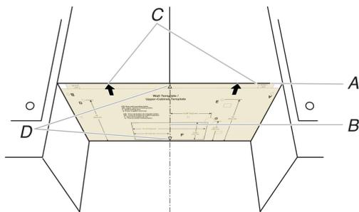
A. Bord avant de la plaque de carton et bord avant de l'armoire supérieure
