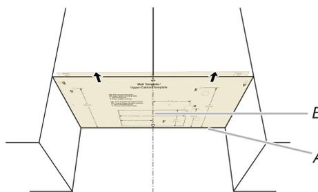
A. Bord arrière de la plaque de carton et bord arrière de l'armoire supérieure
