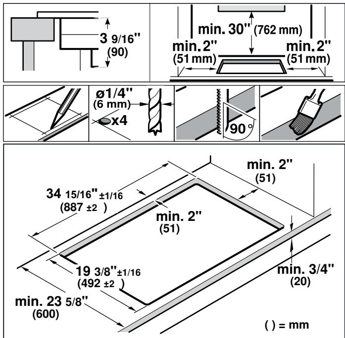
**Montaje a ras de superficie:** se puede realizar un montaje a ras de superficie de la encimera.
