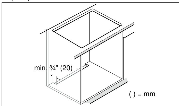
**Remarque :** Si l'appareil électroménager est installé dans un îlot ou un autre type d'installation qui n'est pas décrit dans le présent document, vous devez vous assurer que la table de cuisson est dotée d'une ventilation appropriée.
