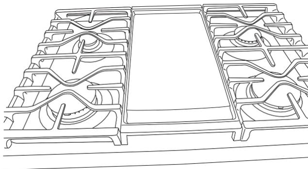
Remplacer la grille centrale (le cas échéant) par la plaque chauffante antiadhésive en aluminium
