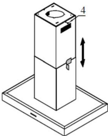
Faites glisser le conduit intérieur vers le haut lentement et doucement pour éviter les rayures. Fixez le tout à l'aide de deux vis sur le cadre du plafond
