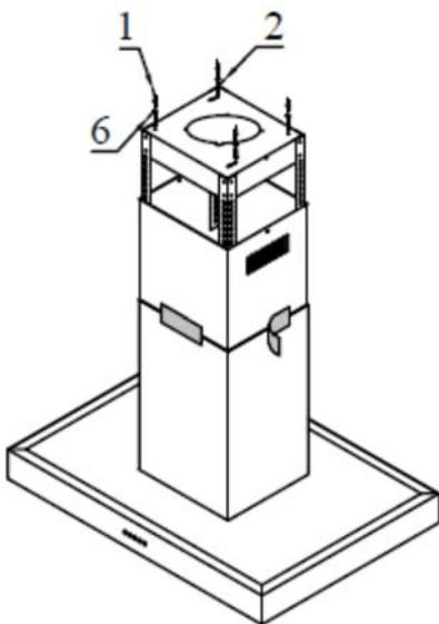
Soulevez la hotte et fixez le cadre au plafond en vous assurant qu'il est suffisamment solide pour supporter le poids de la hotte. Ensuite, raccordez l'alimentation électrique et le système de canalisation
