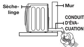
2. Utilisez un conduit d'évacuation métallique rigide de 10.2 cm. Scellez tous les joints à l'aide d'un ruban adhésif, y compris au niveau du sèche-linge. N'utilisez jamais de vis, qui entraînent l'accumulation de peluches.
