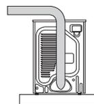
4. Nettoyez tous les anciens conduits avant d'installer votre nouveau sèche-linge. Vérifiez que le clapet d'air s'ouvre et se ferme sans problème. Inspectez et nettoyez le système d'évacuation une fois par an.
