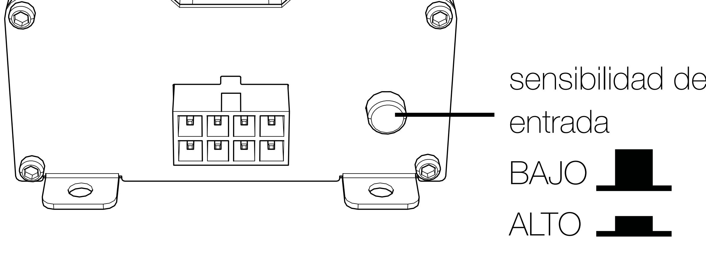
En el espectro de configuración LO, hay una carga de  $60 \Omega$  aplicada para usarse con los radios inteligentes más nuevos que interrumpen sus salidas si no detectan un altavoz conectado a la unidad de alimentación. Si es necesario cargar una unidad de alimentación que tenga un voltaje de salida superior a 10 V, use los productos KISLOAD en vez de las resistencias de carga integradas de KEYLOC.
