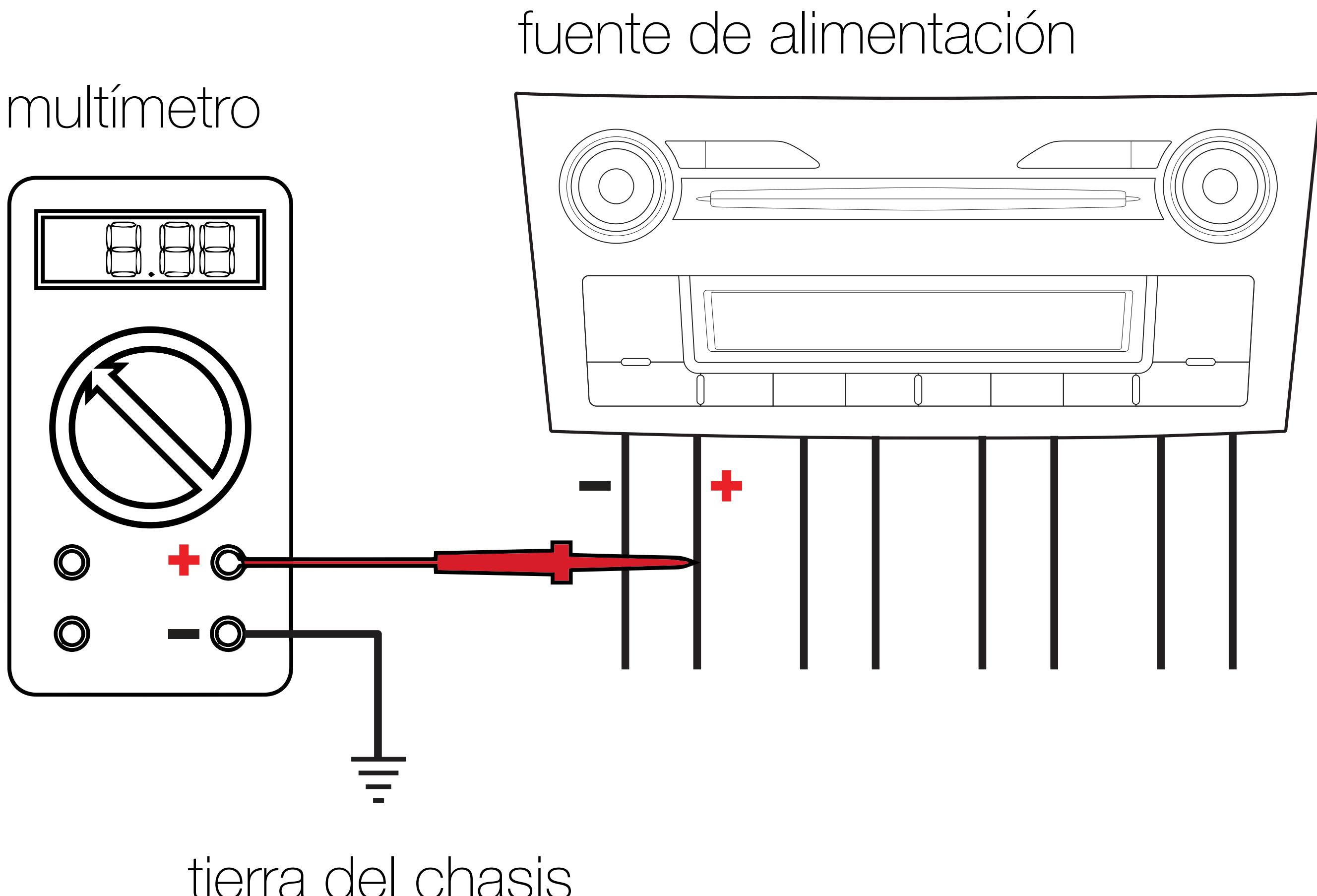
Debe haber voltaje de CC presente en el cable de su altavoz. El voltaje de CC debe estar entre 2.5 y 6 V de CC para poder encender el KEYLOC. Si el cable de activación remota es rojo no es necesario utilizarlo.
