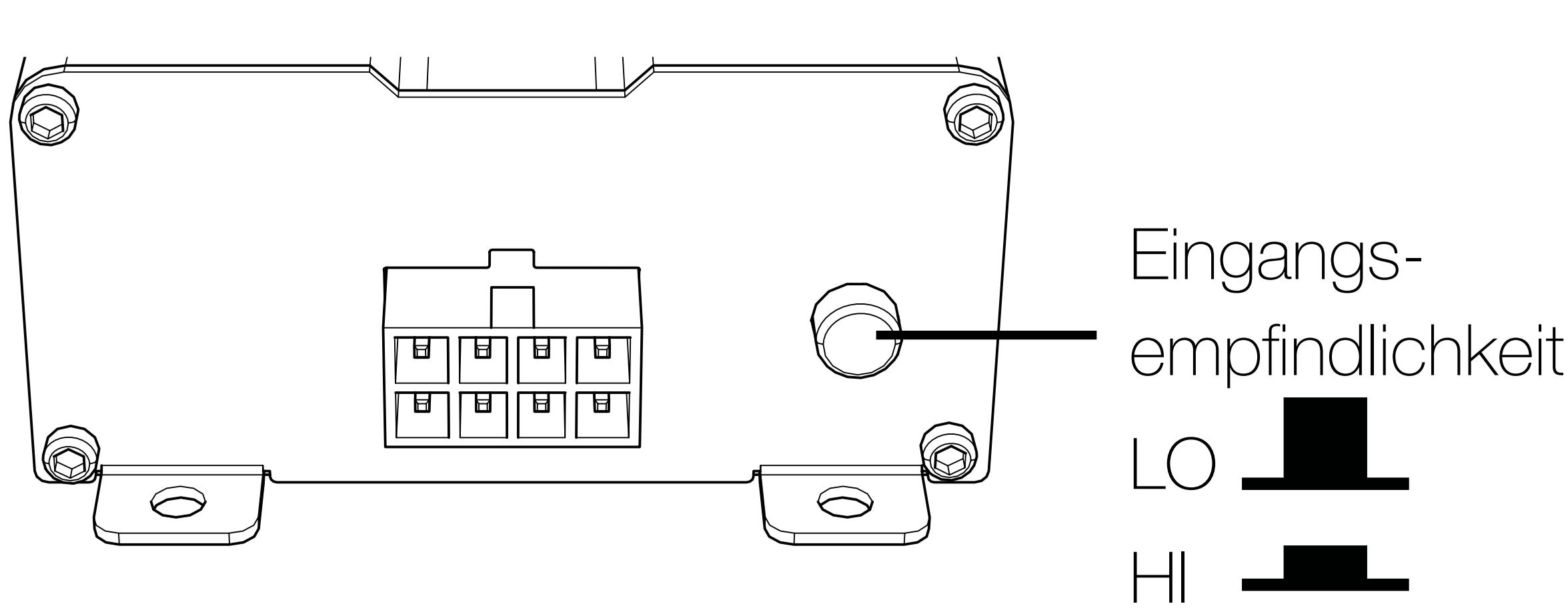
Im LO-Einstellbereich ist eine  $60\text{-}\Omega$ -Last für die Verwendung mit neueren Smart-Radios angebracht, die ihre Ausgänge abschalten, wenn sie keinen an die Quelleinheit angeschlossenen Lautsprecher erkennen. Wenn eine Quelleinheit mit einer Ausgangsspannung von mehr als 10 V belastet werden muss, verwenden Sie bitte die KISLOAD-Produkte anstelle der im KEYLOC eingebauten Lastwiderstände.
