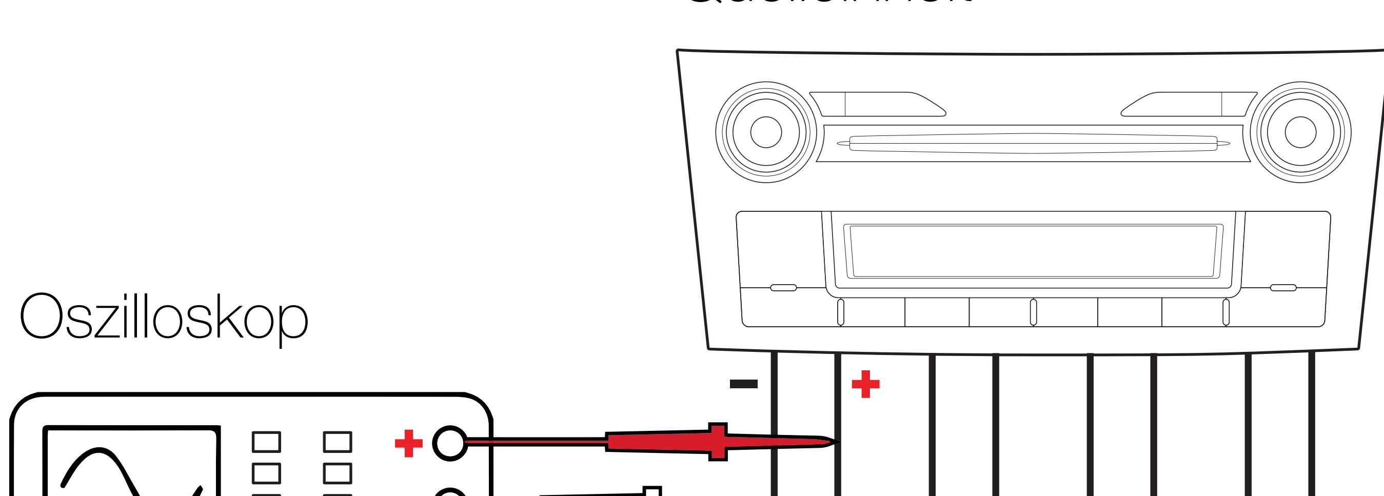
**1.** Schließen Sie Ihre Oszilloskopsonden wie gezeigt an die Lautsprecherleitungen (+) und (-) an.
