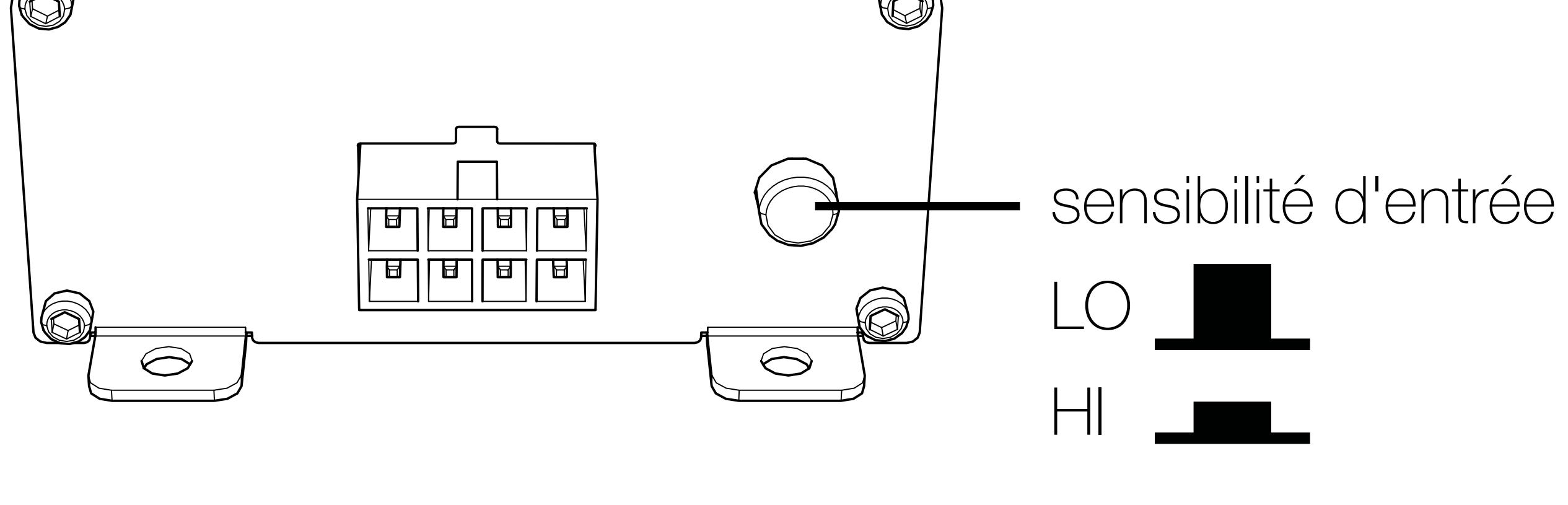
Dans la plage de réglage LO, il y a une charge de  $60 \Omega$  appliquée pour une utilisation avec les radios intelligentes plus récentes qui coupent leurs sorties si elles ne détectent pas de haut-parleur connecté à la source. S'il est nécessaire de charger une unité source ayant un voltage de sortie supérieur à 10 V, veuillez utiliser les produits KISLOAD au lieu des résistances de charge intégrées du KEYLOC.
