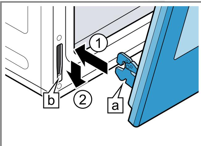
L'angle de la porte peut nécessiter un léger ajustement pour permettre d'engager les charnières convenablement et d'abaisser la porte en place. La porte devrait s'abaisser d'environ 3/4 po (2 cm) et s'arrêter. Si ce n'est pas le cas, les charnières ne se sont pas engagées correctement et la porte pourrait tomber si elle était libérée.
