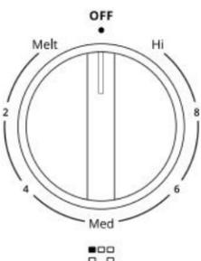
Les boutons de commande peuvent être réglés à n'importe quelle puissance entre « Hi » (élevée) et « Lo » (basse) ou Melt (fondre). Pour régler, enfoncer et tourner le bouton au réglage souhaité.
