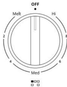
Las perillas de control pueden fijarse en cualquier ubicación entre "Hi" (Alta) y "Lo" (Baja) o Melt (Derretir). Empuje y gire hasta el ajuste deseado.
