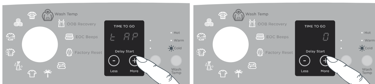
Fig.26 Modification du réglage de température de lavage Cold pour sélectionner Controlled Cold
