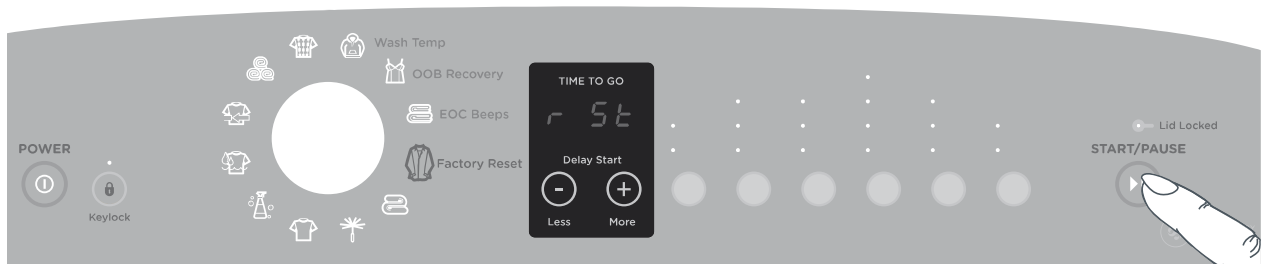
Fig.29 Réinitialisation des réglages de la laveuse aux valeurs par défaut
