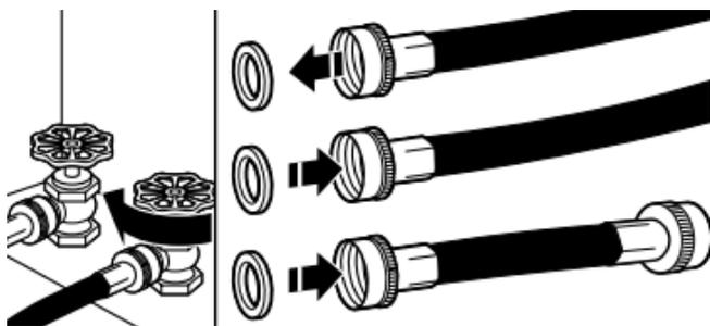
Fermer le robinet d'eau froide et ôter le tuyau d'alimentation de la laveuse. Retirer l'ancien joint de caoutchouc du tuyau d'arrivée d'eau et le remplacer par un joint de caoutchouc neuf.
