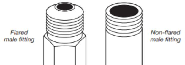
Retirer le capuchon rouge de la canalisation de gaz. À l'aide d'une clé pour serrer, raccorder l'alimentation en gaz à la sècheuse. Utiliser un composé d'étanchéité des tuyauteries sur tous les filetages des raccords mâles non coniques. Si on utilise un conduit métallique souple, veiller à ce qu'il ne soit pas pincé.
