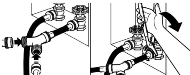
Fixer les extrémités du tuyau d'alimentation de 5 pi (1,5 m) au connecteur en "Y". Fixer le tuyau d'alimentation en eau froide de la laveuse à l'autre extrémité du raccord en "Y". Visser le raccord à la main jusqu'à ce qu'il. Terminer le serrage des raccords de deux tiers de tour supplémentaire avec une pince.
