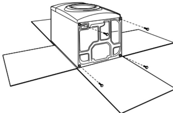
Afin d'éviter d'endommager le plancher, utiliser un grand morceau de carton plat extrait de la boîte d'emballage de la sècheuse et le placer sous toute la partie arrière de la sècheuse. Saisir fermement le corps de la sècheuse (et non pas le panneau de la console) puis reposer la sècheuse sur le carton avec précaution.
