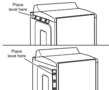
Vérifier l'aplomb de la sécheuse d'un côté à l'autre. Répéter l'opération de l'avant vers l'arrière.
