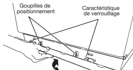
**Installation :** Placer la jupe au bas de la sécheuse et faire correspondre les goupilles de positionnement avec les trous. Appuyer sur la jupe fermement vers le haut jusqu'à ce qu'elle s'enclenche.
