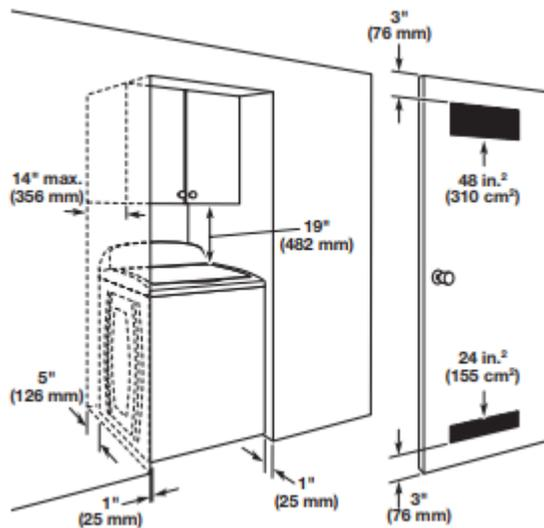
**REMARQUE :** Aucun autre appareil consommant un combustible ne doit être installé dans la même armoire que la sècheuse.
