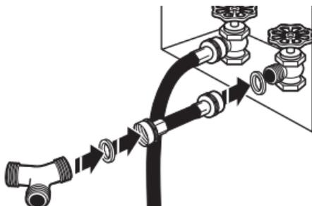
Fixer le tuyau d'alimentation de 2 pi (0,6 m) au robinet d'eau froide. Visser le raccord à la main jusqu'à ce qu'il repose sur le robinet. Fixer le raccord en "Y" à l'extrémité mâle du tuyau d'alimentation de 2 pi (0,6 m). Visser le raccord à la main jusqu'à ce qu'il repose sur le raccord.
