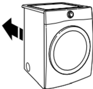
Déplacer la sécheuse à son emplacement final. Éviter d'écraser ou de déformer le conduit d'évacuation.
