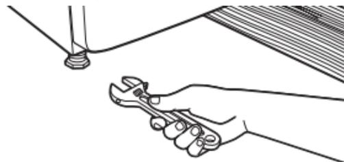
Si la sécheuse n'est pas d'aplomb, la relever à l'aide d'un bloc de bois. Utiliser une clé pour ajuster les pieds vers le haut ou vers le bas, et vérifier à nouveau si elle est d'aplomb.
