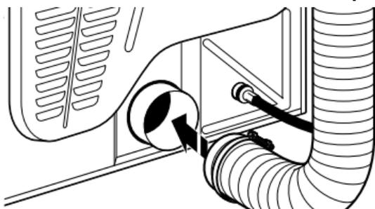
À l'aide d'une bride de fixation de 4" (102 mm), relier le conduit d'évacuation à la bouche d'évacuation de la sécheuse. Si on utilise le conduit d'évacuation existant, s'assurer qu'il est propre. Le conduit d'évacuation doit être fixé par-dessus la bouche d'évacuation de la sécheuse et à l'intérieur du clapet d'évacuation. S'assurer que le conduit d'évacuation est fixé au clapet d'évacuation à l'aide d'une bride de fixation de 4" (102 mm).
