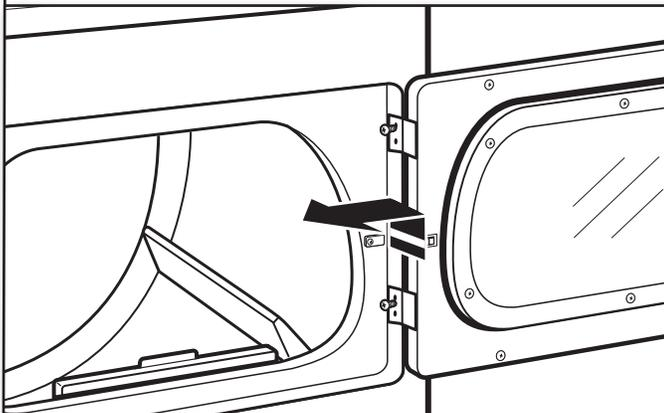
Soulever la porte jusqu'à ce que les vis supérieures situées dans la caisse de la sècheuse se trouvent dans la partie évasée de l'encoche de charnière. Tirer la porte vers l'avant pour la dégager des vis. Placer la porte (côté poignée vers le haut) sur la sècheuse. Retirer les vis supérieures de la caisse de la sècheuse.
