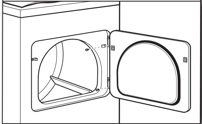
Ouvrir la porte de la sécheuse. Ôter les vis inférieures du côté charnière de la caisse de la sécheuse. Desserrer (ne pas retirer) les vis supérieures du côté charnière de la caisse de la sécheuse.
