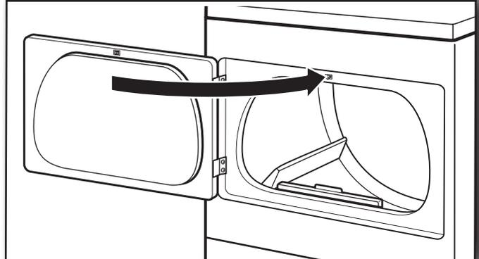
Fermer la porte et vérifier que la gâche de la porte est alignée avec le piton de retenue de la porte. Au besoin, faire glisser le piton de retenue de la porte vers la gauche ou vers la droite à l'intérieur de l'encoche pour régler l'alignement.
