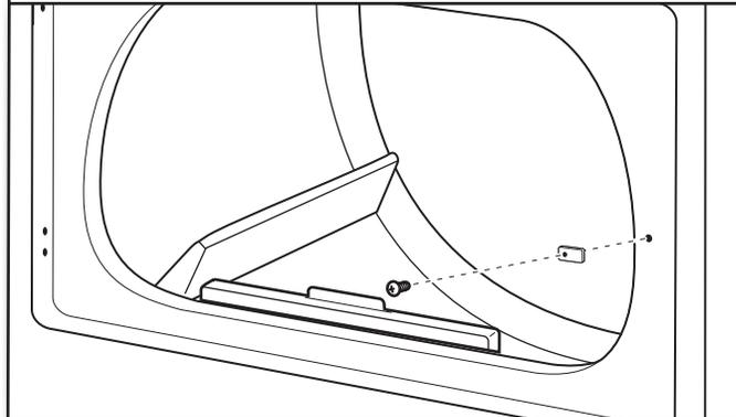
Retirer le bouchon d'obturation de la gâche de porte. Insérer la gâche de la porte retirée à l'étape 10 dans le trou et la fixer avec une vis. Insérer le bouchon d'obturation de la gâche de porte dans le trou de gâche de porte d'origine, puis fixer avec une vis.
