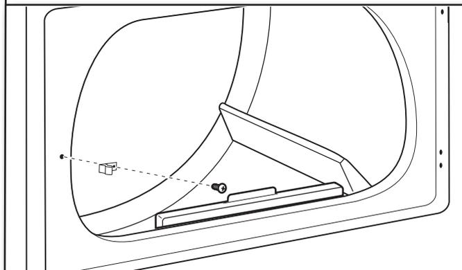
Détacher la gâche de porte de la caisse de la sécheuse et la mettre de côté.
