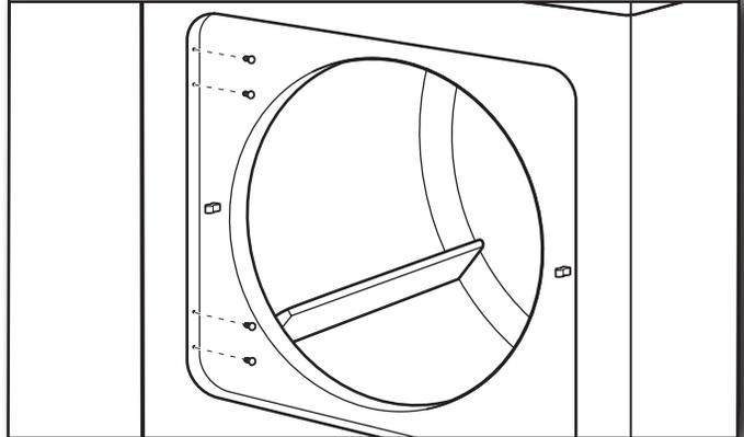
Utiliser un petit tournevis à lame plate pour retirer avec précaution les 4 bouchons d'obturation du côté gauche de la caisse de la sècheuse. Insérer les bouchons d'obturation dans les trous de charnière, du côté opposé de la caisse de la sècheuse.
