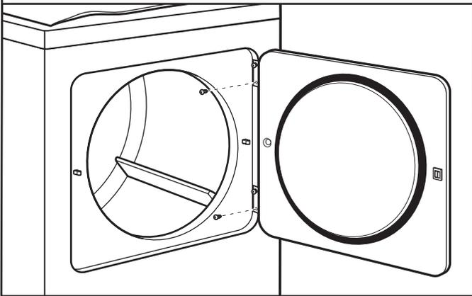
Ouvrir la porte de la sècheuse. Ôter les vis inférieures du côté charnière de la caisse de la sècheuse. Desserrer (ne pas retirer) les vis supérieures du côté charnière de la caisse de la sècheuse.
