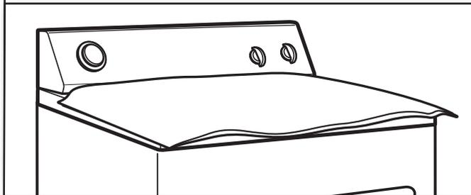
Placer la serviette sur le dessus de la sécheuse pour éviter d'endommager la surface.
