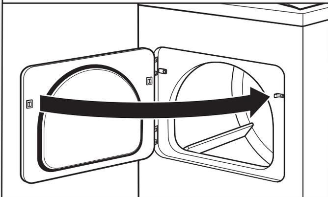
Fermer la porte et vérifier que la gâche de la porte est alignée avec le pignon de retenue de la porte. Au besoin, faire glisser le pignon de retenue de la porte vers la gauche ou vers la droite à l'intérieur de l'encoche pour régler l'alignement.
