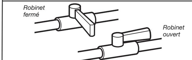
Ouvrir le robinet d'arrêt de la canalisation d'alimentation; le robinet est ouvert lorsque la manette est parallèle à la canalisation de gaz. Vérifier ensuite tous les raccordements en les badigeonnant d'une solution de détection de fuites non corrosive approuvée. L'apparition de bulles indique la présence d'une fuite. Réparer toute fuite éventuelle.
