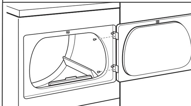
Ouvrir la porte de la sécheuse. Ôter les vis inférieures du côté charnière de la caisse de la sécheuse. Desserrer (ne pas retirer) les vis supérieures du côté charnière de la caisse de la sécheuse.
