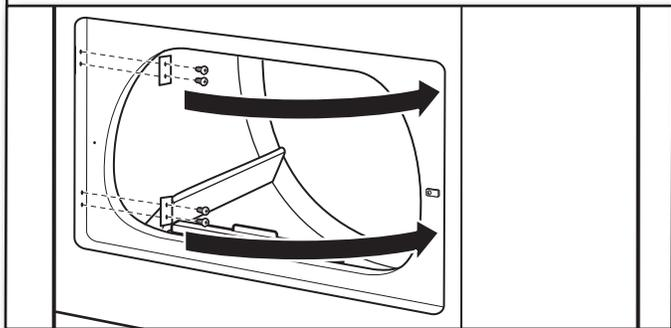
Ôter les 4 vis fixant les 2 bouchons d'obturation du côté gauche. Transférer les bouchons d'obturation au côté opposé à l'aide des mêmes 4 vis.
