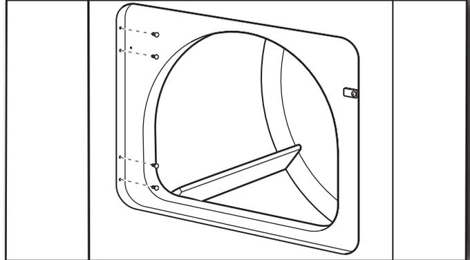
Utiliser un petit tournevis à lame plate pour retirer avec précaution les 4 bouchons d'obturation du côté gauche de la caisse de la sècheuse. Transférer les bouchons d'obturation dans les trous de charnière du côté opposé de la caisse de la sècheuse.
