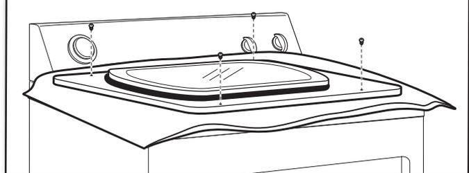
Retirer les vis du sommet, du bas et du côté de la porte (4 vis). Conserver séparément les vis de porte et les vis de charnière, car elles sont de tailles différentes.
