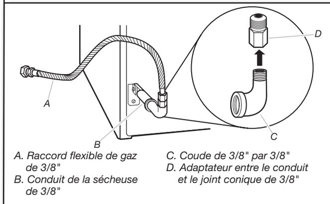
On doit utiliser une combinaison de raccords de tuyauterie pour raccorder la sécheuse à l'alimentation en gaz existante. L'illustration présente un raccordement recommandé. Le raccordement peut varier selon le type, la taille et l'emplacement de la canalisation d'alimentation.
