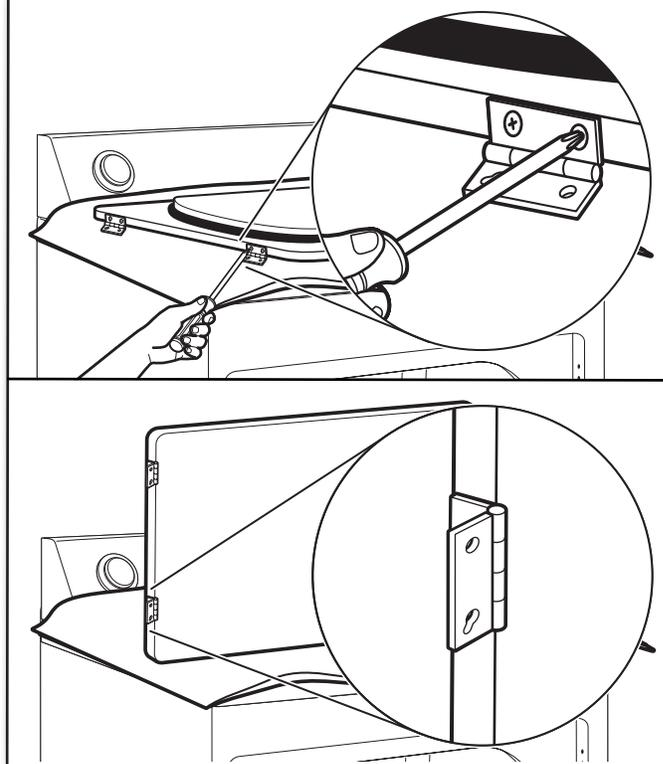
Réinstaller les charnières de porte sur la porte de la sècheuse de façon à ce que le trou le plus gros se trouve dans la partie inférieure de la charnière.
