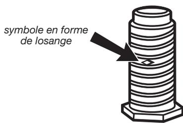
Examiner les pieds de nivellement et trouver le symbole en forme de losange. Introduire manuellement les vis des pieds dans les trous pour pieds; utiliser une clé à molette pour visser les pieds jusqu'à ce que le symbole de losange ne soit plus visible.
