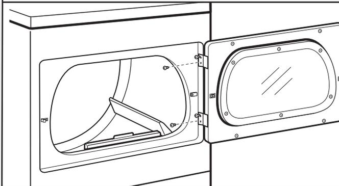
Ouvrir la porte de la sècheuse. Ôter les vis inférieures du côté charnière de la caisse de la sècheuse. Desserrer (ne pas retirer) les vis supérieures du côté charnière de la caisse de la sècheuse.
