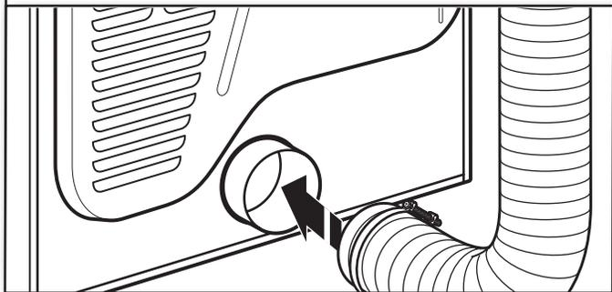
À l'aide d'une bride de serrage de 4" (102 mm), relier le conduit d'évacuation à la bouche d'évacuation de la sécheuse. Si on utilise le conduit d'évacuation existant, s'assurer qu'il est propre. Le conduit d'évacuation de la sécheuse doit être fixé par-dessus la bouche d'évacuation de la sécheuse, et à l'intérieur du clapet d'évacuation. Vérifier que le conduit d'évacuation est fixé au clapet d'évacuation à l'aide d'une bride de serrage de 4" (102 mm).
