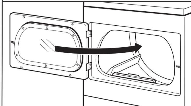
Fermer la porte et vérifier que la gâche de la porte est alignée avec le pignon de retenue de la porte. Au besoin, faire glisser le pignon de retenue de la porte vers la gauche ou vers la droite à l'intérieur de l'encoche pour régler l'alignement.
