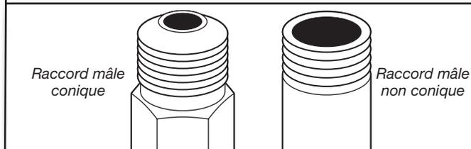
Retirer le capuchon rouge de la canalisation de gaz. À l'aide d'une clé pour serrer, raccorder l'alimentation en gaz à la sécheuse. Utiliser un composé d'étanchéité des tuyauteries sur tous les filetages des raccords mâles non coniques. Si on utilise un conduit métallique souple, veiller à ce qu'il ne soit pas pincé.
