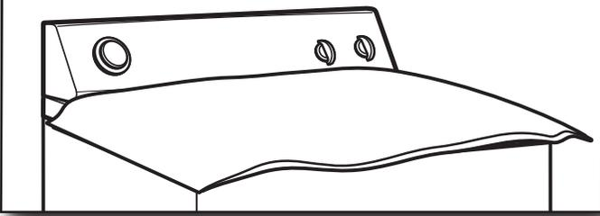
Placer la serviette sur le dessus de la sècheuse pour éviter d'endommager la surface.
