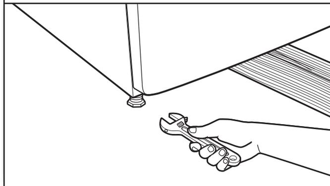
Si la sécheuse n'est pas d'aplomb, la relever à l'aide d'un bloc de bois. Utiliser une clé pour ajuster les pieds vers le haut ou vers le bas, et vérifier à nouveau si elle est d'aplomb. Une fois que les pieds sont d'aplomb, s'assurer que les quatre pieds sont solidement appuyés contre le plancher avant de les serrer.
