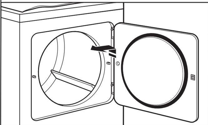
Soulever la porte jusqu'à ce que les vis supérieures dans la caisse se trouvent dans la partie large de l'encoche de la charnière. Tirer la porte vers l'avant pour la dégager des vis. Placer la porte sur la sècheuse. Retirer les vis supérieures de la caisse de la sècheuse.
