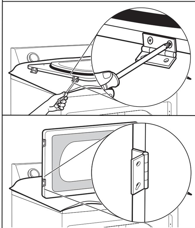
Réinstaller les charnières de porte sur la porte de la sécheuse de façon à ce que le trou le plus gros se trouve dans la partie inférieure de la charnière.
