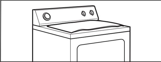
Placer la serviette sur le dessus de la sècheuse pour éviter d'endommager la surface.
