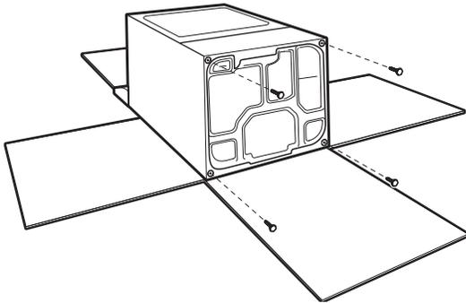
Pour ne pas endommager le plancher, utiliser un grand morceau de carton découpé dans l'emballage de la sècheuse; le placer sous tout le bord arrière de la sècheuse. Saisir fermement la sècheuse par la caisse (non par le panneau de commande) et incliner soigneusement la sècheuse sur le carton.
