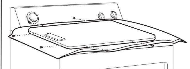
Retirer les vis du sommet, du bas et du côté de la porte (6 vis). Conserver séparément les vis de porte et les vis de charnière, car elles sont de tailles différentes. Tout en maintenant la porte sur la serviette et sur la sècheuse, saisir les côtés de la porte externe et la soulever pour la séparer de la porte interne.
