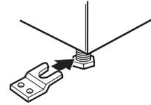
Les installations en maison mobile nécessitent un ensemble d'ancrage au sol pour installation en maison mobile. Pour le processus de commande, consulter le Guide d'utilisation et d'entretien.
