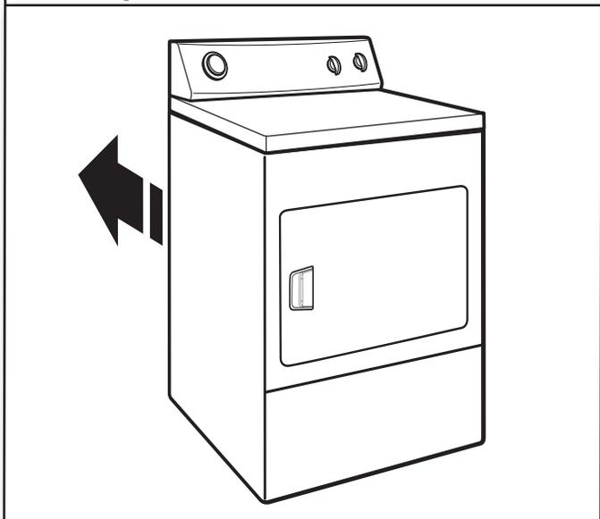
Placer la sécheuse à son emplacement final. Éviter d'écraser ou de déformer le conduit d'évacuation. Une fois que la sécheuse est à son emplacement définitif, ôter les cornières et le carton du dessous de la sécheuse.
