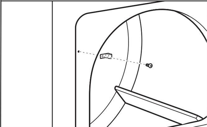
Détacher la gâche de porte de la caisse de la sècheuse et la mettre de côté.
