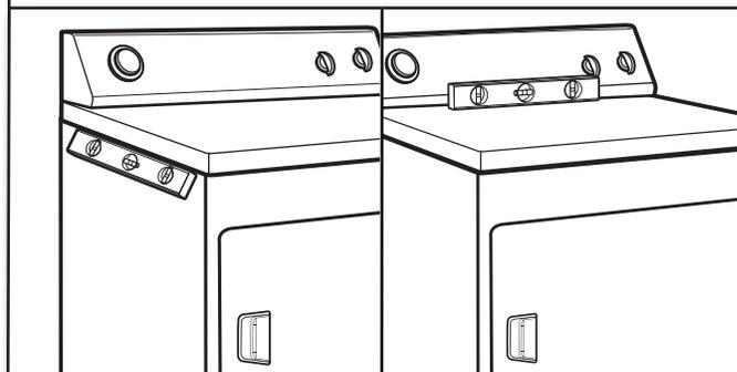
Vérifier l'aplomb de la sécheuse d'un côté à l'autre. Répéter l'opération de l'avant vers l'arrière.
