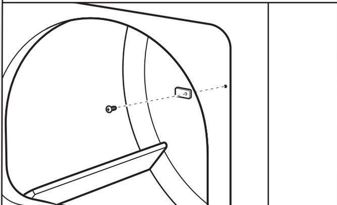
Retirer le bouchon d'obturation de la gâche de porte. Insérer la gâche de la porte retirée à l'étape 9 dans le trou et la fixer avec une vis. Insérer le bouchon d'obturation de la gâche de porte dans le trou de gâche de porte d'origine, puis fixer avec une vis.
