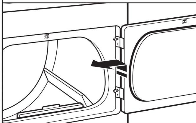
Soulever la porte jusqu'à ce que les vis supérieures situées dans la caisse de la sécheuse se trouvent dans la partie évasée de l'encoche de charnière. Tirer la porte vers l'avant pour la dégager des vis. Placer la porte (côté poignée vers le haut) sur la sécheuse. Retirer les vis supérieures de la caisse de la sécheuse.
