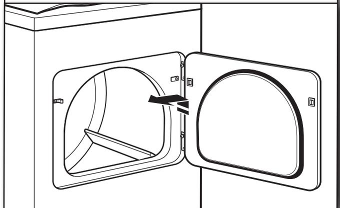
Soulever la porte jusqu'à ce que les vis supérieures situées dans la caisse de la sécheuse se trouvent dans la partie évasée de l'encoche de charnière. Tirer la porte vers l'avant pour la dégager des vis. Placer la porte (côté poignée vers le haut) sur la sécheuse. Retirer les vis supérieures de la caisse de la sécheuse.
