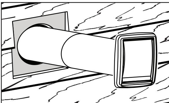
5. Inserte el conducto a través del agujero en pared y sujeté el conducto al conducto del metal. Utilice la cinta del conducto en todas las conexiones del conducto para hacerlas seguras y herméticas.
