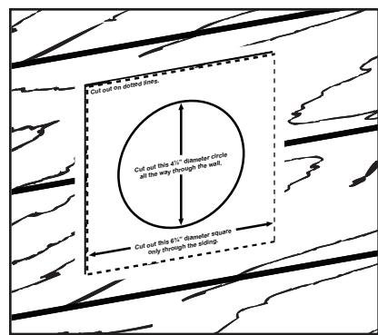
1. Corte la plantilla abajo y remonte el contorno en la pared. Evite la colocación donde se localiza el cableado o la plomería de la casa.
