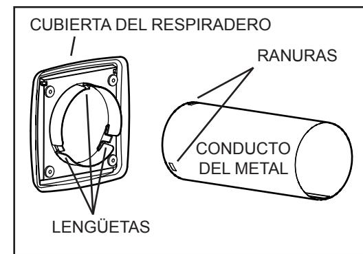
3. Conecte el CONDUCTO DEL METAL junto. Encaje a presión las RANURAS en conducto hacia LENGÜETAS en la CUBIERTA DEL RESPIRADERO.
