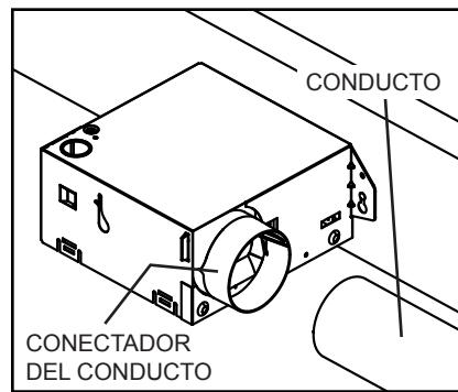
4. Una el CONDUCTO al empalme de CONECTADOR DEL CONDUCTO.
