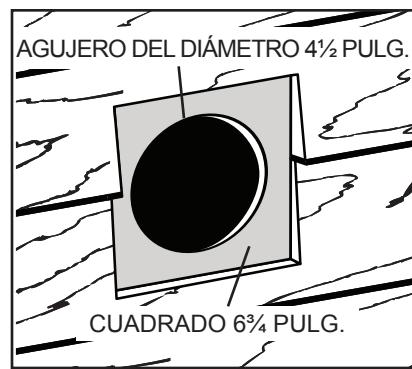
2. Corte el AGUJERO DEL DIÁMETRO 4 1/2 PULG. completamente la pared. Si la pared no es plana: Quite el cualquier apartadero o la otra cubierta de pared externa por dentro del CUADRADO 6 1/4 PULG. - para crear una superficie plana.
