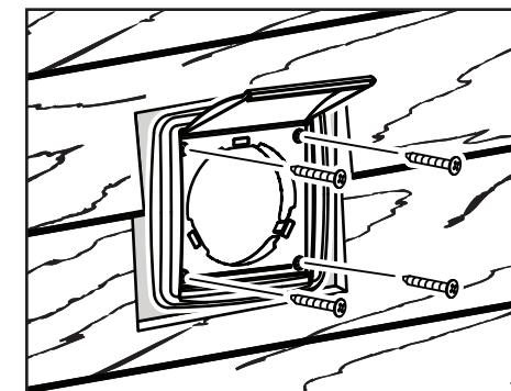
6. Segura el cubierta del respiradero a la pared con 4 tornillos (incluidos). Calafatee alrededor de la cubierta del respiradero con un compuesto del calafateo de la calidad.
