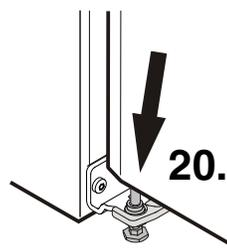
20. Suspend bottom door on hinge pin.
