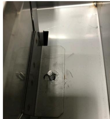
HEARTH BURNER SLOT MUST ENGAGE POST
