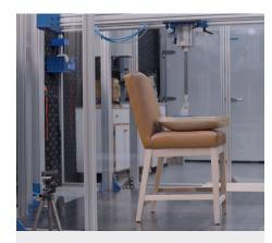
Une grande pression est exercée sur le siège pendant qu'une traction est exercée sur le dossier pour assurer la solidité de l'assemblage. Nos chaises et tabourets sont conçus et testés jusqu'à une capacité de 450 livres.
