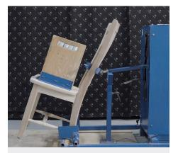
En laboratoire, pendant plusieurs heures, on simule le mouvement de bascule pour vérifier la résistance de l'assemblage et la durabilité de la chaise.
