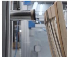
La chute d'une chaise sur le sol ou un coup de pied sont aussi simulés à l'aide du test du marteau. Nous répétons l'opération plusieurs fois et nous vérifions qu'il n'y ait pas de détachement, de fissure ou de rupture.
