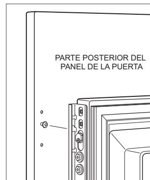
Montaje del panel de la puerta
