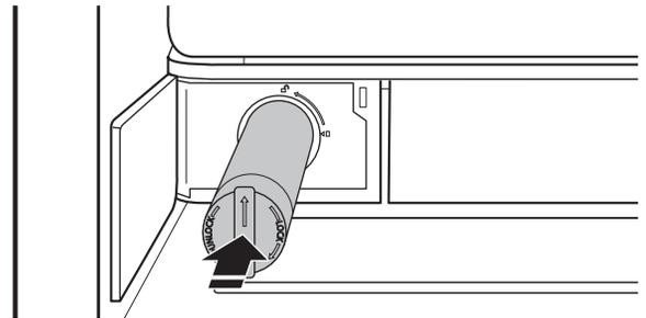
7. Faire tourner le filtre de 90° dans le sens horaire jusqu'à ce qu'il soit verrouillé en place et que les flèches soient alignées.
