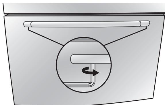
4. En tournant la clé de gauche à droite, serrer la vis de blocage d'un quart de tour à la fois, jusqu'à ce qu'elle commence à toucher la vis à épaulement. Ne pas serrer complètement.
