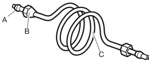
A. Bague de compression C. Tube en cuivre
