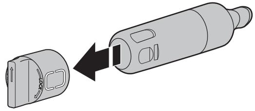
5. Installer le capuchon de filtre à eau sur le nouveau filtre. Aligner correctement les flèches pour aligner les rainures du filtre et les nervures du capuchon.
