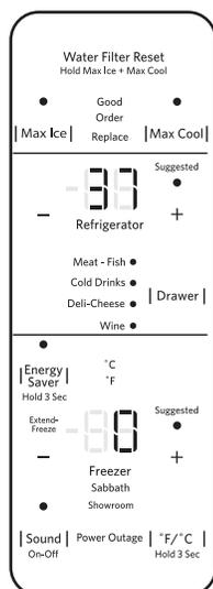
Pour activer le mode Température du garde-manger, appuyer sur DRAWER ( tiroir ), puis choisir entre les 4 options de réglage de température : Viandes, poissons, spécialités, fromages, produits marinés et vin. L'affichage indique le point de réglage de température du garde-manger.
