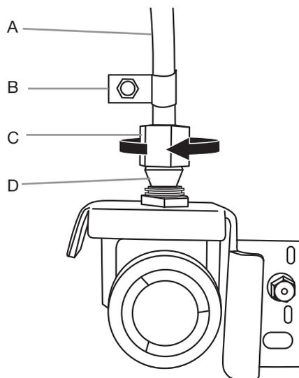
A. Tube en cuivre C. Écrou à compression
