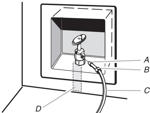
A. Bague C. Canalisation en cuivre (jusqu'au réfrigérateur)
