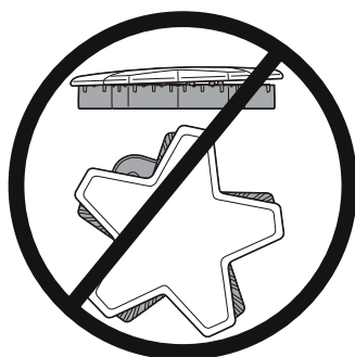
Tapa del quemador incorrecta
