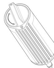
3. Le compartiment du filtre à eau se trouve du côté droit du plafond du réfrigérateur. Pousser le loquet sur la porte du filtre pour dégager le fermoir puis abaisser la porte.
