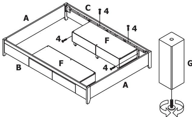
TURN LEVELER UNDERNEATH STORAGE FEET (G) TO ADJUST THE STORAGES (F) LEVEL AS SHOWN ON ILLUSTRATION.
