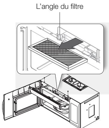
6. Placez un filtre à charbon actif neuf en le faisant coulisser. Le filtre doit être installé selon l'angle indiqué sur la figure.
