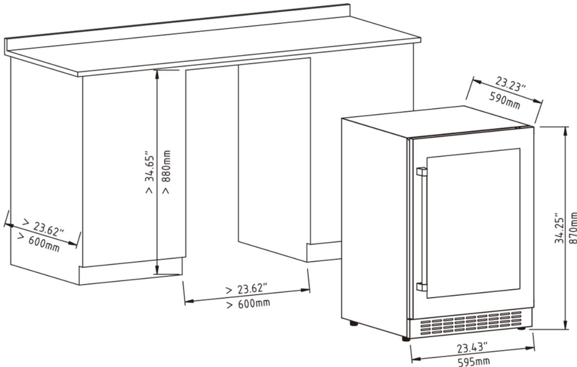
Remarque : Si l'appareil est entièrement intégré pour être installé avec une plinthe de cuisine, assurez-vous que les espaces de ventilation dans la plinthe mesurent au moins 300 cm<sup>2</sup> et retirez les grilles de ventilation, afin que l'air chaud puisse se disperser sans obstacle. Sinon, l'appareil fonctionnera plus intensément, ce qui entraînera une augmentation de la consommation électrique.
