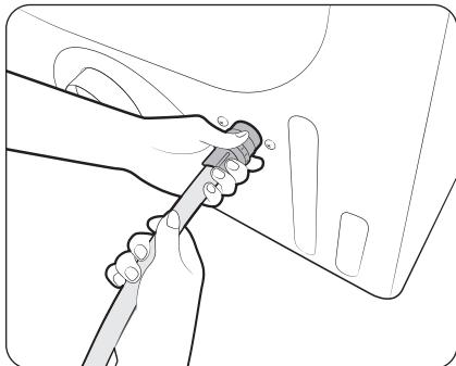
1. Branchez la partie coudée du tuyau d'eau au robinet de remplissage situé à l'arrière, en bas du sèche-linge. Tournez le raccord à la main jusqu'à ce qu'il soit bien serré.
