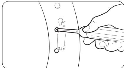
5. Retirez les deux vis situées au-dessus et en dessous de la découpe sur l'avant du châssis.
