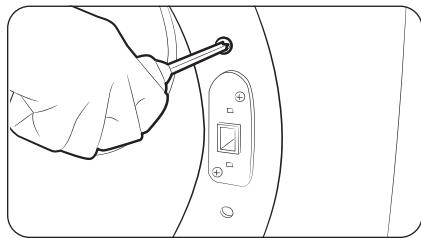
13. Réinstallez les vis restantes sur les trous restants, au-dessus et en dessous du dispositif de fermeture, puis serrez-les.
