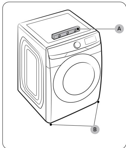
Assurez-vous que le sèche-linge est à niveau de droite à gauche et de l'avant à l'arrière à l'aide d'un **niveau** (A). Si le sèche-linge n'est pas de niveau, tournez les **pieds réglables** (B) dans le sens horaire pour abaisser le sèche-linge ou dans le sens antihoraire pour soulever le sèche-linge.
