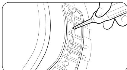
10. Insérez la vis que vous venez de retirer dans l'autre trou de vis, à l'arrière de la charnière du hublot, puis serrez-la.
