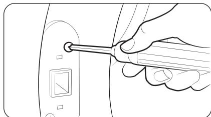
7. Retirez les deux vis qui tiennent le support du dispositif de fermeture en place, puis enlevez le support du dispositif de fermeture.
