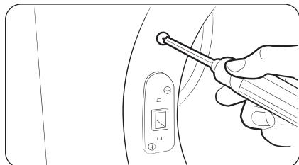
6. Retirez les deux vis situées au-dessus et en dessous du dispositif de fermeture sur le côté opposé de l'ouverture du hublot.
