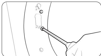
8. Réinsérez les deux vis qui fixaient le support du dispositif de fermeture dans les mêmes trous de vis, puis serrez-les.
