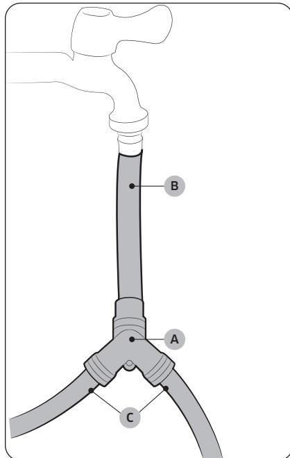
1. Fermez le robinet d'eau froide. Si le tuyau d'eau froide du lave-linge est raccordé au robinet d'eau froide, dévissez-le et débranchez-le. Ensuite, raccordez le **tuyau court (B)** au robinet d'eau froide. Tournez le raccord à la main jusqu'à ce qu'il soit bien serré.
