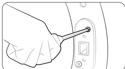
12. Poussez le support du dispositif de fermeture dans le découpage, de l'autre côté de l'ouverture du hublot. Insérez les vis, puis serrez-les comme indiqué.
