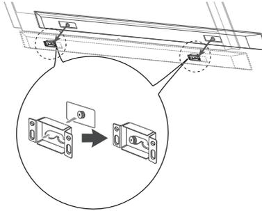
**8** Fixez fermement l'appareil sur les supports muraux à l'aide des vis fournies.
