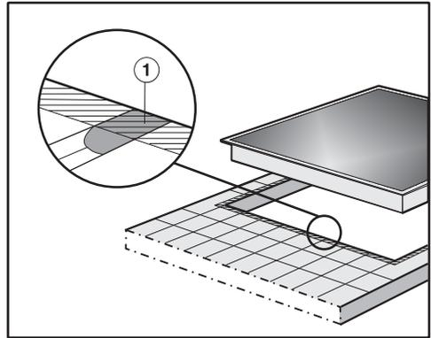
Le joint ① et la zone ombragée sous le cadre de la surface de cuisson doivent être lisses et plats de façon à assurer une pose uniforme du cadre sur le comptoir et à garantir la bonne étanchéité du joint de scellement sous le rebord supérieur de l'appareil avec le comptoir.
