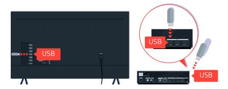
Insérez la clé USB dans la fente située à l'arrière de votre téléviseur ou sur le côté du boîtier One Connect.
