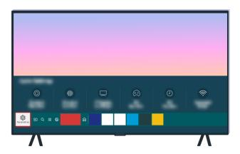
Sélectionnez (a) > (a) Paramètres > Support tech. > Assistance pour l'appareil > Autodiagnostic > Informations sur le signal pour vérifier la force du signal.
