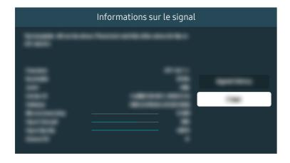
Celle-ci doit être de plus de 20 dB (plus de quatre bandes sur l'icône) pour que la réception soit stable.
