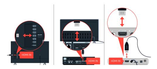
D'abord, débranchez et rebranchez les cordons d'alimentation et les câbles HDMI de l'arrière de votre téléviseur ou du boîtier One Connect (OC), puis débranchez le cordon d'alimentation de la prise avant de le rebrancher.
