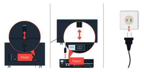
D'abord, débranchez et rebranchez les cordons d'alimentation et les câbles HDMI de l'arrière de votre téléviseur ou du boîtier One Connect (OC), puis débranchez le cordon d'alimentation de la prise avant de le rebrancher.
