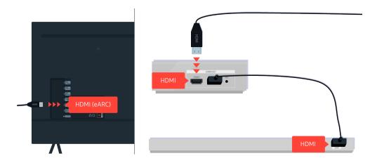
Si votre barre de son est connectée à un récepteur, qui lui, est branché au téléviseur au moyen d'un câble HDMI, vérifiez le connecteur HDMI situé à l'arrière du téléviseur. Le câble doit être branché au port HDMI (eARC) de votre téléviseur.
