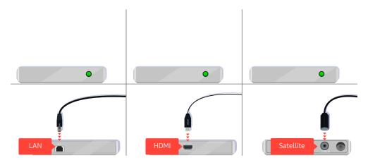
Si vous utilisez un boîtier adaptateur, vérifiez le branchement du câble. Le câble à vérifier variera selon le type de boîtier adaptateur.
