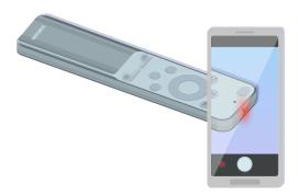
Vous pouvez vérifier si le signal est transmis en appuyant sur la touche de mise en marche et en observant l'extrémité avant de la télécommande par l'entremise de la caméra de votre téléphone intelligent.
