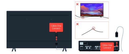
Si le problème persiste, et si votre téléviseur utilise la fonction Câble One Connect, débranchez puis rebranchez le câble Câble One Connect dans le téléviseur et le boîtier One Connect (OC). Assurez-vous que le câble Câble One Connect n'est pas pincé ou sérieusement plié.
