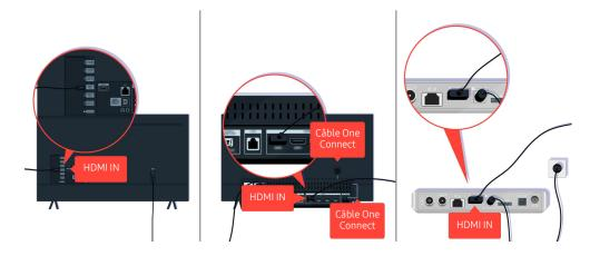
Vérifiez la connexion du câble HDMI avec le téléviseur ou le boîtier One Connect.
