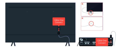
Déconnectez et reconnectez le câble One Connect reliant le téléviseur au boîtier One Connect (OC). Assurez-vous que le câble One Connect n'est pas pincé ou sérieusement plié.
