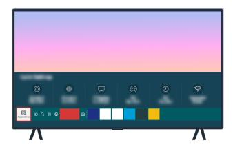
Sélectionnez 🚳 > 🕸 Paramètres > Support tech. > Assistance pour l'appareil > Autodiagnostic > Essai d'image.
