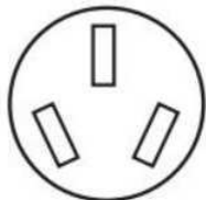
Tomacorriente de 3 hilos (10-50R)
