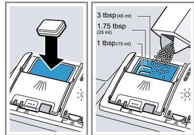
Si des pastilles sont utilisées, une seule suffit. Disposer la pastille horizontalement. Si vous utilisez du détergent en poudre ou liquide, observez les indications de dosage du fabricant et la graduation du dosage du compartiment à détergent. 1,5 à 1,75 cuillères à soupe (20 à 25 ml) de détergent suffisent pour la vaisselle à souillure normale. Si la vaisselle est peu sale, une quantité de détergent légèrement inférieure à celle indiquée suffira habituellement.
