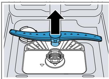
3. Sous l'eau courante, s'assurer que les buses de sortie des bras d'aspersion sont dégagées et éliminer les corps étrangers au besoin.
