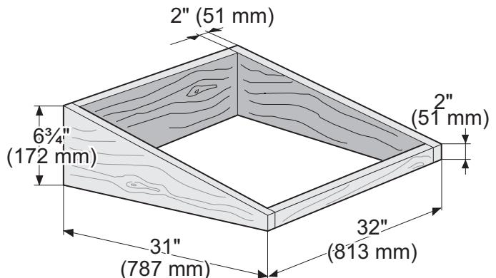
Para la instalación sobre un techo plano o sobre techos con una inclinación de menos de 10°, instale la unidad en la mocheta como se muestra. Coloque la mocheta sobre techos planos de modo que el extremo de la descarga apunte hacia el lado opuesto a los vientos predominantes.
