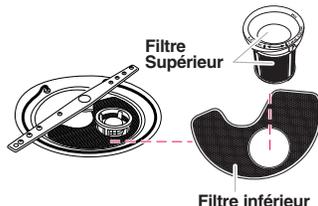
**IMPORTANT :** Afin d'éviter d'endommager le lave-vaisselle, ne pas le faire fonctionner sans que les filtres ne soient correctement installés. S'assurer que le filtre inférieur est bien en place et que le filtre supérieur est bien emboîté. Si le filtre supérieur tourne librement, cela signifie qu'il n'est pas bien emboîté.
