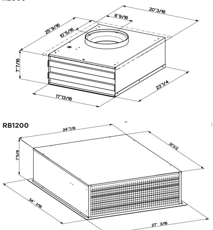
NOTE: MAKE SURE THE DISCHARGE END OF THE REMOTE BLOWER FACES AWAY FROM THE DIRECTION OF THE PREVAILING WINDS. INSTALL THE DISCHARGE END OF THE FAN FACING AN UNOCCUPIED SPACE
