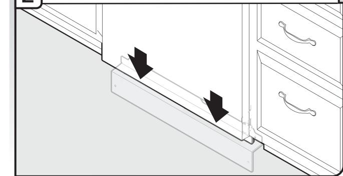
Revise que el borde inferior del panel de acceso haga contacto con el piso. Ajústelo si es necesario.
