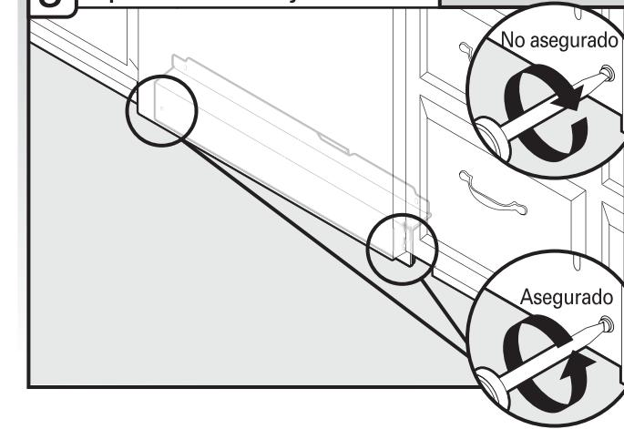
Con un destornillador de hoja plana, gire los sujetadores  $\frac{1}{4}$  giro para asegurarlos en su lugar. La ranura del sujetador estará completamente vertical cuando se asegure correctamente.
