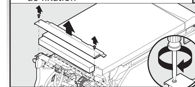
A l'aide d'un tournevis à lame plate, tourner les dispositifs de fixation d'un quart de tour pour les déverrouiller. Retirer le panneau.
