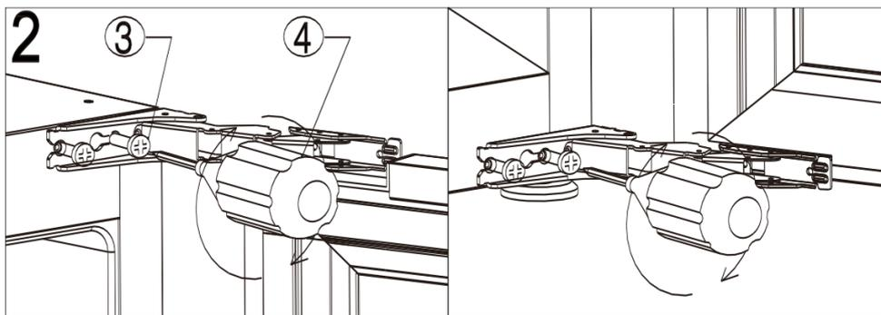
3. Utiliser le tournevis Phillips④ pour retirer la vis à tête fraisée Phillips M5③ qui fixe les charnières supérieure et inférieure de la porte. (Figure 2)
