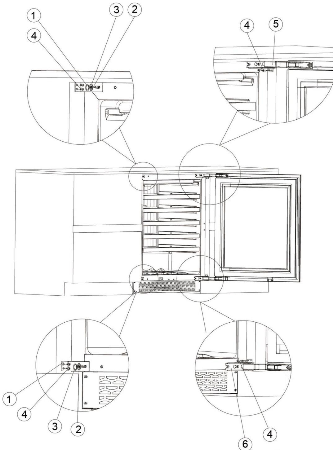
5. Après avoir ajusté le panneau de porte, sortez 4 vis autotaraudeuses ST4x35 du sac d'accessoires, ouvrez le joint de la porte, percez les vis à travers les trous de vis du cadre de la porte et serrez le panneau de porte.
