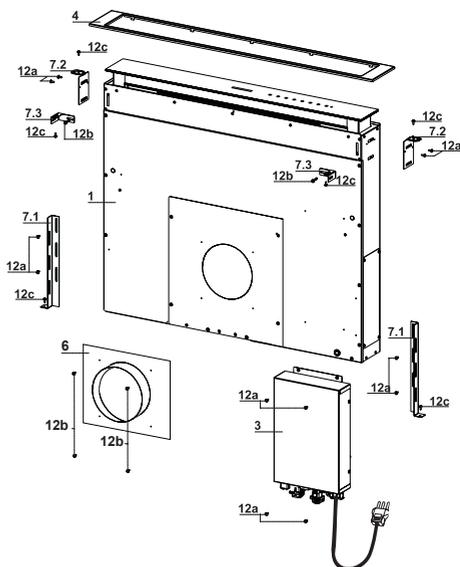
Collier de conduit 10" utilisé avec ventilateurs à distance
