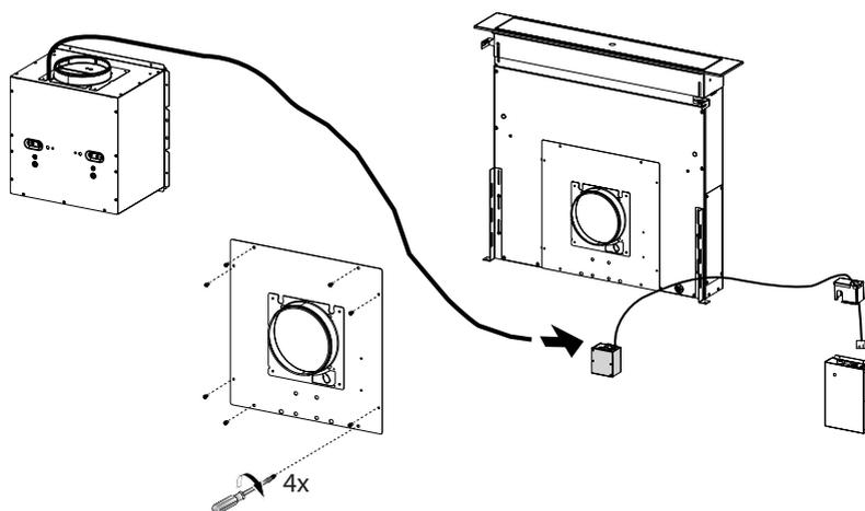
Branchez les fils du ventilateur à distance au connecteur du module électrique.
