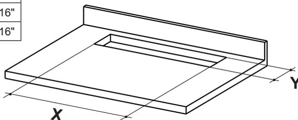
L'écart minimum entre l'ouverture pour la surface de cuisson et l'ouverture pour la hotte doit être d'au moins 1 3/16" - 1 15/16", selon la résistance du matériau du plan de travail.
