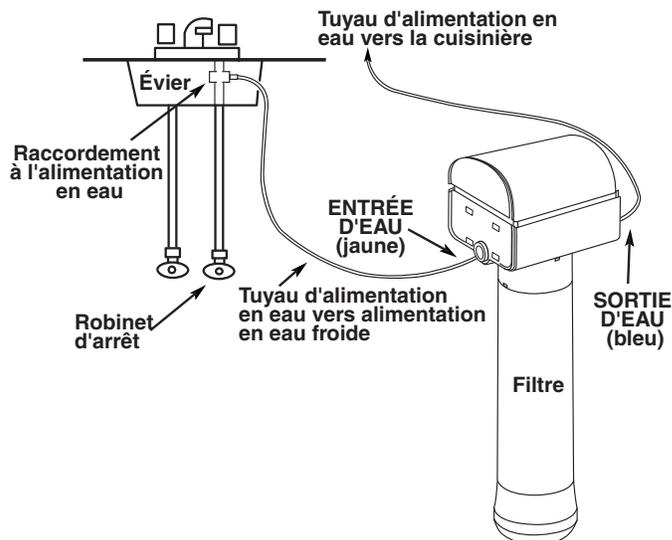
4. Acheminer la canalisation d'alimentation en eau flexible homologuée par les codes en vigueur à travers le placard sous évier et l'ouverture découpée dans le placard pour le four.
