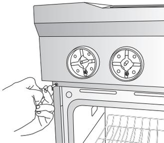
**REMARQUE :** Veiller à laisser la porte du four entrouverte, sans quoi la console de commande ne reposera pas correctement sur les brides latérales une fois détachée.
