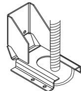
2. Déplacer la cuisinière vers son emplacement final en s'assurant que le pied de nivellement arrière glisse dans la bride antibasculement.
