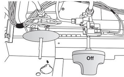
8. Tourner le bouton de commande à LO (faible) et allumer le brûleur avec un briquet à butane allongé.
