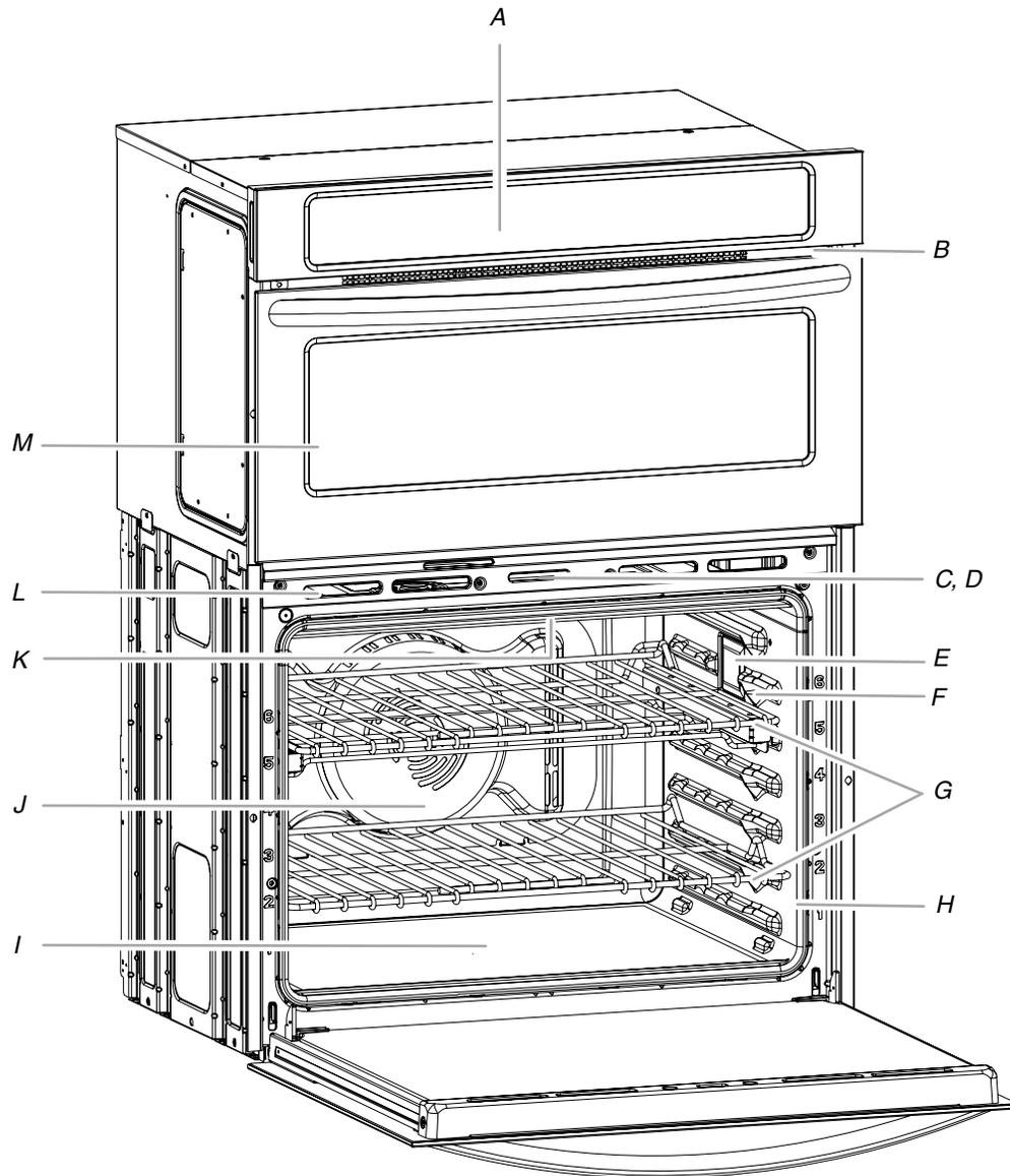
A. Module de commande électronique du four
