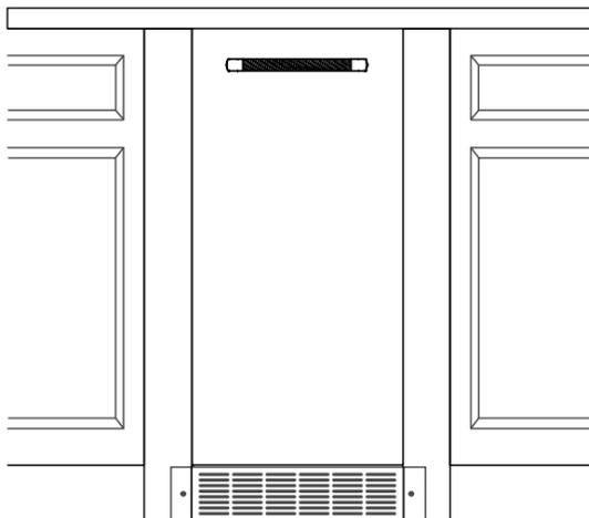
6. À l'aide du foret de 1/8 po, percer les trous dans les armoires. Ils permettent d'utiliser des vis no 8-18 x 0,750 po.
