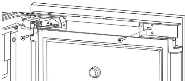
6. Effectuer l'ajustement gauche-droite du panneau pour obtenir l'espace désiré de chaque côté. Installer les vis restantes sur le panneau de porte en passant par les supports.
