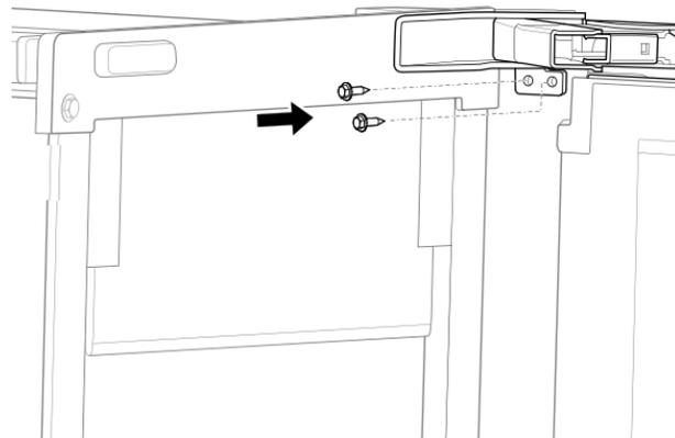
14. Fixer les supports d'armoire (inclus avec la machine à glaçons) aux trous à l'avant de la machine à glaçons comme illustré. Fixer les charnières d'armoire sur le côté de l'armoire en utilisant des vis à bois.
