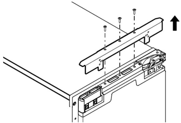
2. Retirer les capuchons supérieur et inférieur en utilisant le tournevis à tête cruciforme et les garder de côté.
