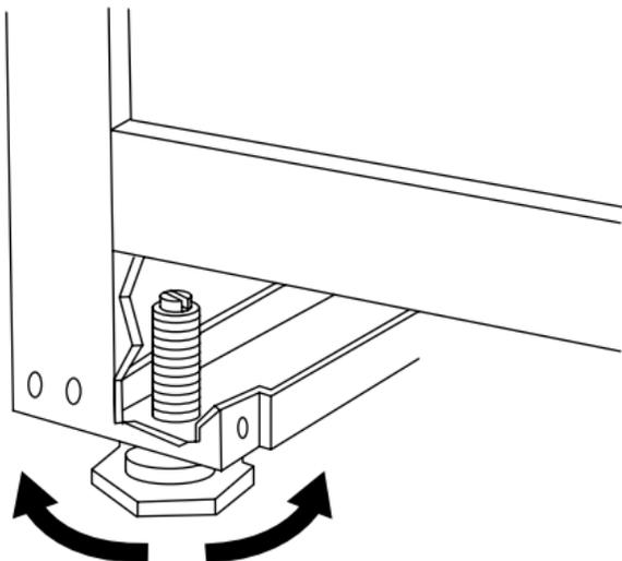
5. Pousser vers le haut sur la partie arrière de la machine à glaçons pour repérer les pieds de nivellement qui se trouvent en bas à l'arrière de la machine à glaçons.
