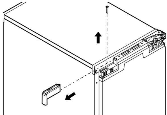
3. Replacer le support de métal du haut en utilisant les vis retirées à l'étape 1.
