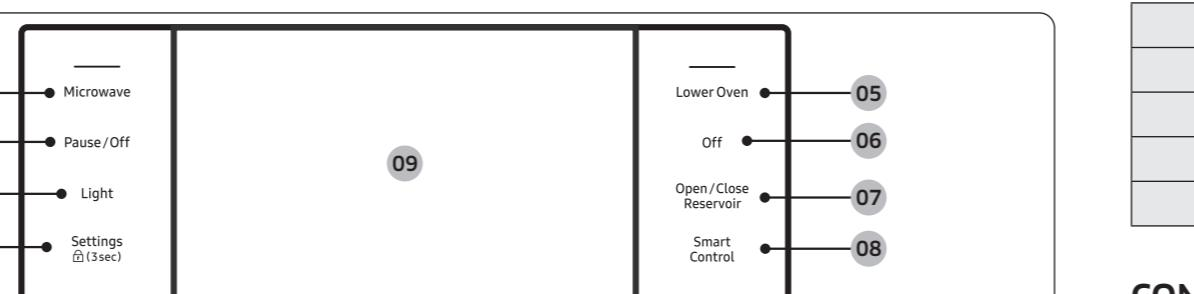
**01 Microwave (Microondas)** : Se utiliza para mostrar la pantalla del modo de horno microondas superior. Tocar esto no enciende ni apaga el horno. Solamente muestra el estado actual.
