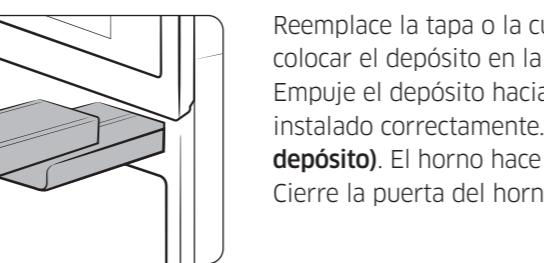
Reemplace la tapa o la cubierta de plástico transparente y vuelva a colocar el depósito en la ranura. Empuje el depósito hacia adentro. Se oirá un ligero clic cuando esté instalado correctamente. Toque Open/Close Reservoir (Abrir/Cerrar depósito). El horno hace retroceder el depósito de agua. Cierre la puerta del horno.
