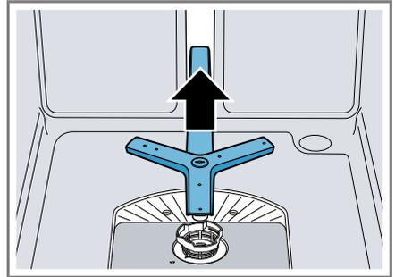
4. Vérifier si les buses de sortie des bras d'aspersion sont encrassées en les passant sous l'eau courante et retirer tout corps étranger.
