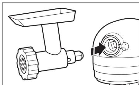
**3** Insérer l'accessoire dans la prise à accessoires, en s'assurant que l'arbre de commande s'adapte à la douille de prise carrée. Il faudra peut-être faire pivoter l'accessoire en l'insérant. Lorsqu'il est en position correcte, le goujon de l'accessoire s'adapte à l'encoche du pourtour de la prise.
