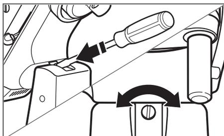
**(OPTIONEL) Pour régler le batteur avec le dégagement du bol :** Incliner la tête de moteur vers l'arrière, puis tourner légèrement la vis dans le sens antihoraire (gauche) pour soulever le batteur ou horaire (droite) pour l'abaisser. Régler le batteur pour qu'il ne touche pas à la surface du bol. Le surajustement de la vis pourrait empêcher le levier de verrouillage de fonctionner correctement.
