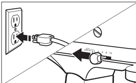
Brancher le batteur sur socle sur une prise à 3 alvéoles reliée à la terre. Toujours régler la commande de vitesse à la plus basse vitesse pour commencer, puis augmenter graduellement la vitesse pour éviter que les ingrédients n'éclaboussent. Consulter le « Guide de commande de vitesse » pour sélectionner la vitesse appropriée pour votre recette.
