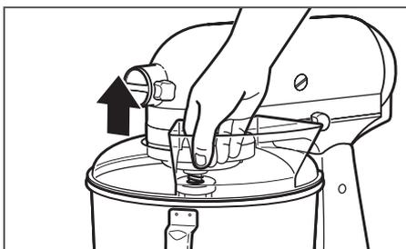
(OPCIONAL) **Retire el escudo vertedor\*:** Levante la parte frontal del escudo vertedor hasta separarla del borde del tazón y sáquelo de la batidora con base.
