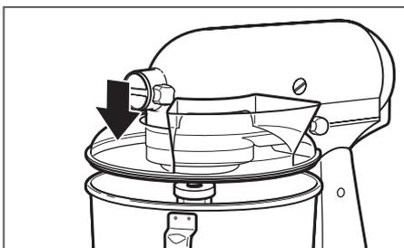
**(OPTIONEL) Ajouter l'écran verseur\* :** Glisser l'écran verseur à partir de l'avant du mélangeur sur socle, par-dessus le bol, jusqu'à ce qu'il soit centré. Le pourtour inférieur de l'écran verseur s'adapte à l'intérieur du bol. Le bec verseur se situera légèrement sur la droite de la prise à accessoires lorsqu'on fait face au batteur sur socle.
