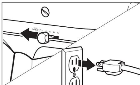
**1** Verifique que la batidora con base esté desconectada y el control de velocidad esté ajustado en "0".
