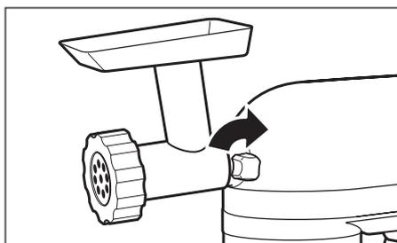
**4** Serrer le bouton à accessoires en tournant dans le sens horaire jusqu'à ce que l'accessoire soit parfaitement fixé au batteur sur socle. Consulter le manuel d'instructions fourni avec votre accessoire pour obtenir des indications précises sur son utilisation.
