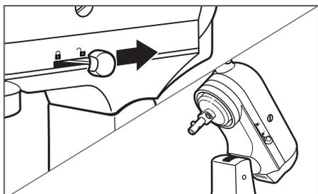
**1 Levante la cabeza con motor:** Verifique que la batidora con base esté desconectada y el control de velocidad esté ajustado en "0"; después deslice la palanca de bloqueo a la posición de desbloqueo y levante la cabeza con motor.
