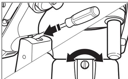
**(OPCIONAL) Para ajustar la distancia entre el batidor y el tazón:** Gire la cabeza con motor hacia atrás; gire el tornillo ligeramente en el sentido opuesto a las agujas del reloj (izquierda) para levantar el batidor o en el sentido de las agujas del reloj (derecha) para bajar el batidor. Ajuste el batidor para dejar un espacio antes de la superficie del tazón. Si ajusta demasiado el tornillo, la palanca del tazón puede no bloquearse en su lugar.
