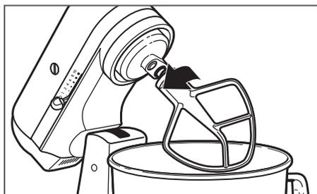
**2** Quite los accesorios: Presione el accesorio hacia arriba tanto como sea posible y gire el accesorio en el sentido de las agujas del reloj para retirarlo del eje del batidor.
