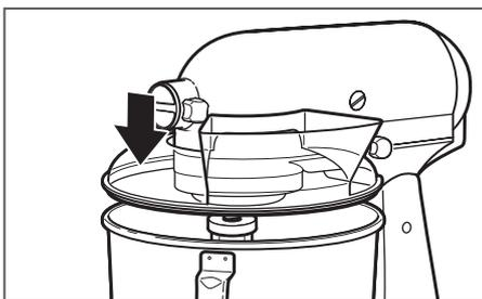
**(OPCIONAL) Coloque el escudo vertedor\*:** Deslice el escudo vertedor desde la parte frontal de la batidora con base sobre el tazón hasta que esté centrado. La parte inferior del borde del escudo vertedor deberá encajar dentro del tazón. El conducto para verter estará a la derecha del eje del aditamento cuando usted esté de frente a la batidora con base.
