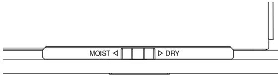
Le curseur de réglage Moist-Dry (humide-sec) permet d'ouvrir ou de fermer les ouvertures d'aération dans la porte. Le réglage MOIST (humide) retient l'humidité tandis que le réglage DRY (sec) permet à la vapeur et à l'humidité de s'échapper du tiroir.
