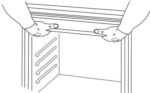
2. Pousser contre la zone du joint du châssis avant pour introduire le four dans le placard, jusqu'à ce que la surface arrière du châssis avant soit au contact de la paroi avant du placard.
