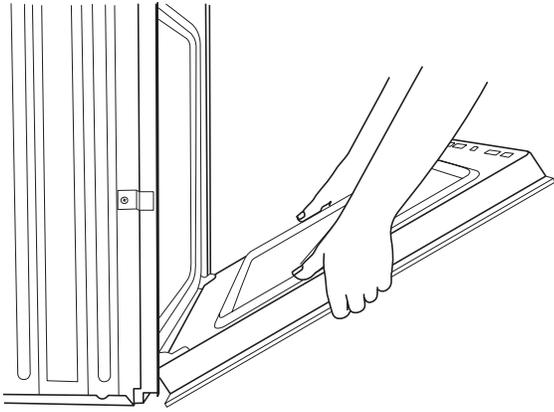
3. Aligner les charnières de porte dans les encoches situées en bas/à l'avant de la cavité du four à un angle de 45°. Insérer doucement la porte tout en veillant à garder un angle de 45°. Lorsque l'on sent un léger abaissement de la porte, cela signifie qu'elle est bien positionnée dans l'encoche.
