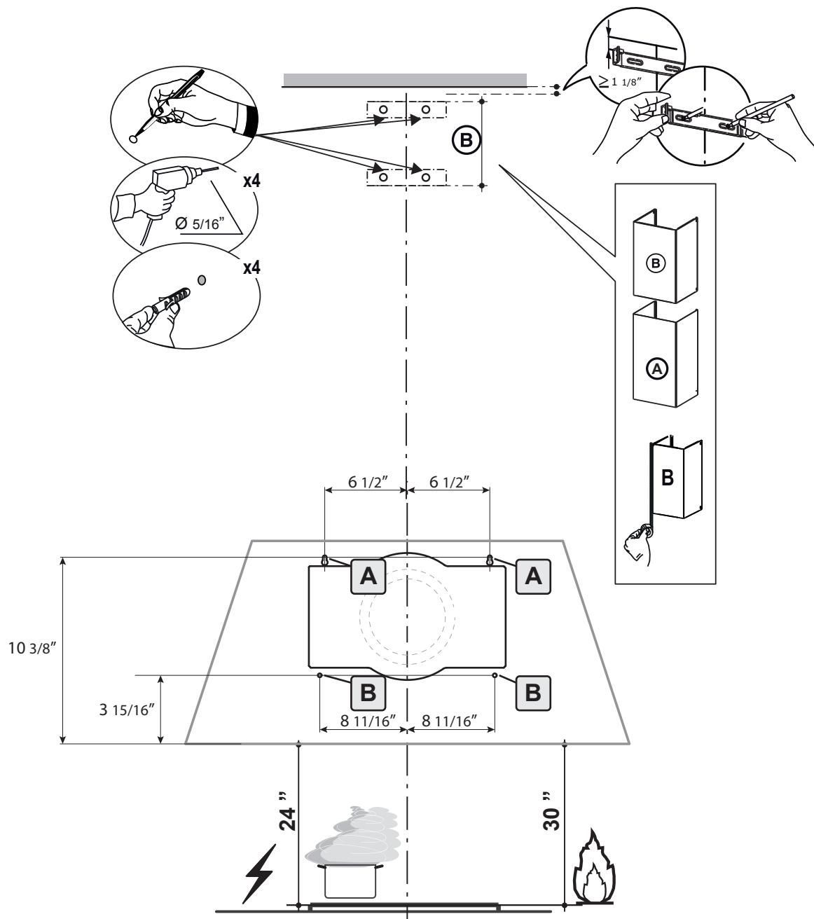
Tracez un repère sur le mur à l'endroit indiqué (A),  $10 \frac{3}{8}''$  au-dessus de la ligne horizontale et à une distance de  $6 \frac{1}{2}''$  à droite et à gauche de la ligne verticale. Vérifiez si les deux marques sont à égalité.
