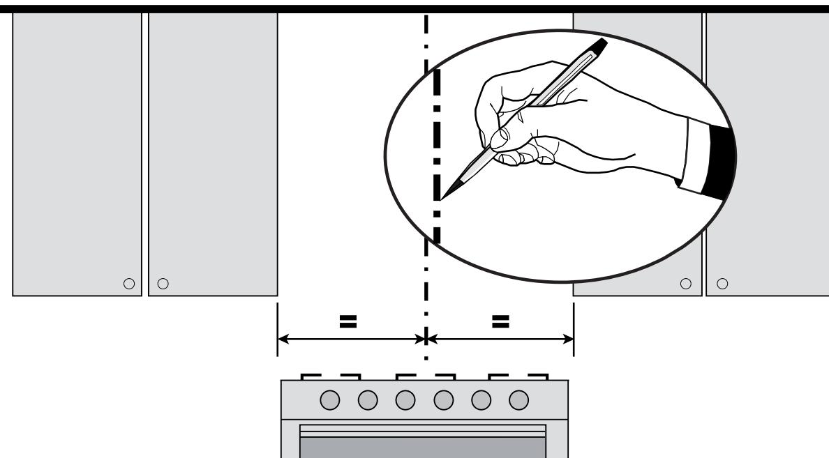
Tracez une ligne verticale sur le mur d'appui le plus haut que possible, au centre de l'emplacement où la hotte sera installée. Tracez une ligne horizontale à l'endroit correspondant au bas de la hotte comme représenté dans l'illustration. Cet emplacement doit se trouver à au moins 24" de la surface de cuisson, si elle est électrique, ou à 30" si elle est au gaz.
