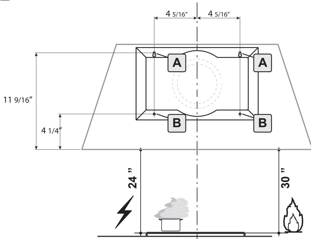
Marque la pared donde se indica (A), 11 9/16" sobre la línea horizontal y a una distancia de 4 5/16" a la izquierda y la derecha de la línea vertical. Comprobando que las dos marcas estén niveladas.
