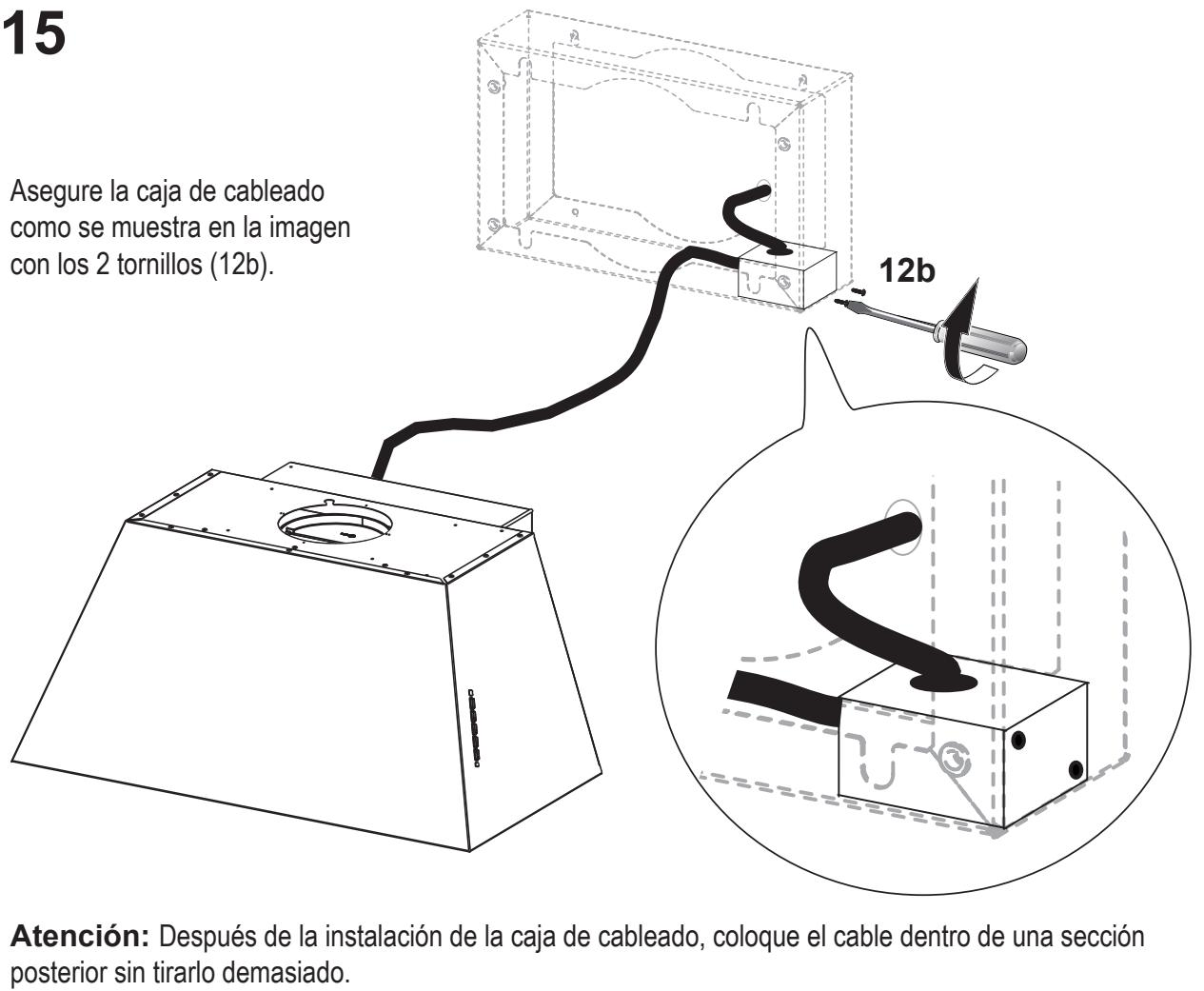
**Atención:** Después de la instalación de la caja de cableado, coloque el cable dentro de una sección posterior sin tirarlo demasiado.
