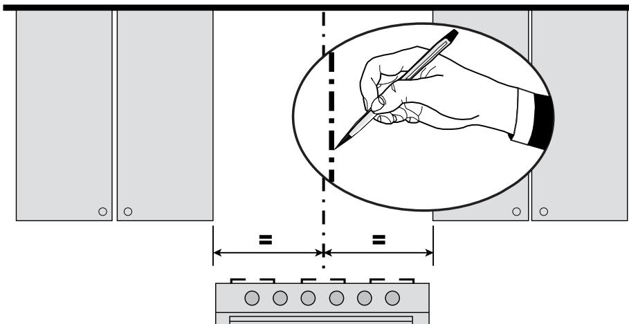
Dibuje una línea vertical en la pared de soporte tan alto como sea posible, en el centro del área donde se instalará la campana. Dibuje una línea horizontal en donde se ubicará el borde inferior de la campana como se indica en la figura que está a un mínimo de 24" sobre la superficie de cocción eléctrica y 30" sobre la de gas.
