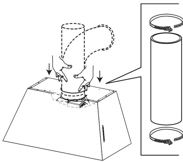
Instale el techo o la tapa de pared comprados por separado. Conecte los conductos metálicos de 6 "al techo o a la tapa de pared y luego conecte los conductos.
