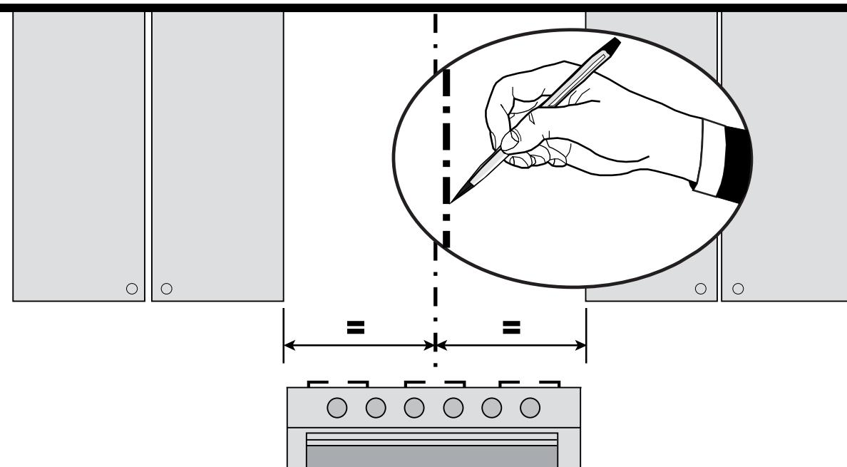
Dibuje una línea vertical en la pared de soporte tan alto como sea posible, en el centro del área donde se instalará la campana. Dibuje una línea horizontal en donde se ubicará el borde inferior de la campana como se indica en la figura que está a un mínimo de 24" sobre la superficie de cocción eléctrica y 30" sobre la de gas.
