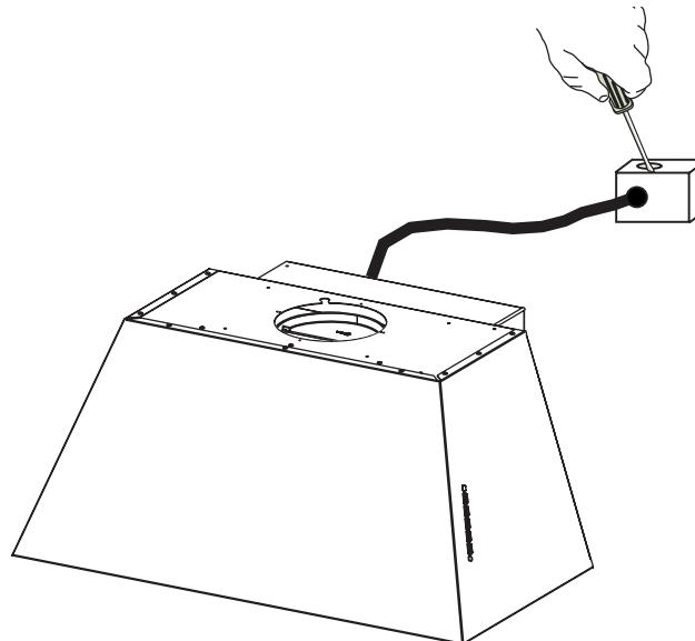
Retire la cubierta del compartimiento de la caja de conexiones desenroscando los dos tornillos.
