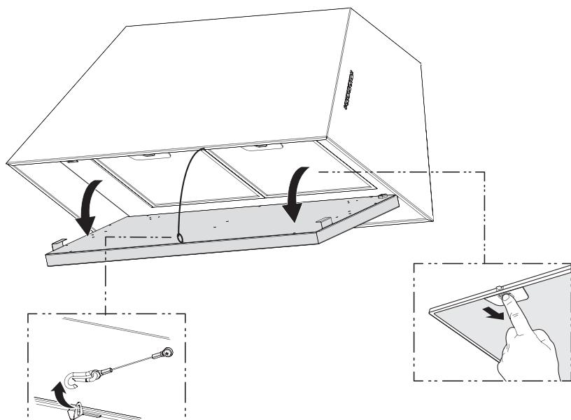
Ouvrez le panneau et dégarez le câble de retenue comme illustré. Retirez les filtres, en poussant simultanément le levier vers l'arrière de l'appareil et en tirant vers le bas. Ne jetez pas les filtres, mais conservez-les pour plus tard.
