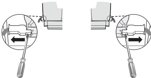
Desde el interior de la campana, utilice un destornillador de cabeza plana, como se muestra en la imagen de arriba, para desconectar los conectores izquierdo y derecho del ventilador.
