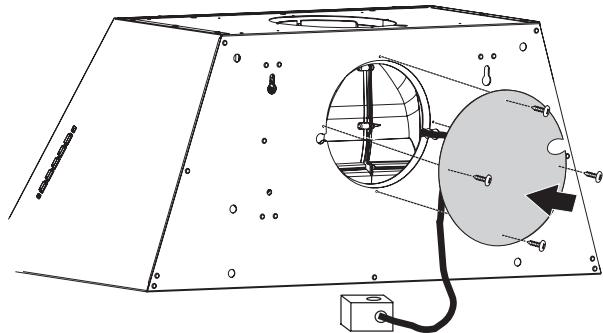
Fije la placa de cubierta con los 4 tornillos retirados previamente y pase la caja de cableado fuera del cuerpo de la campana a través de la muesca en la placa de cubierta.
