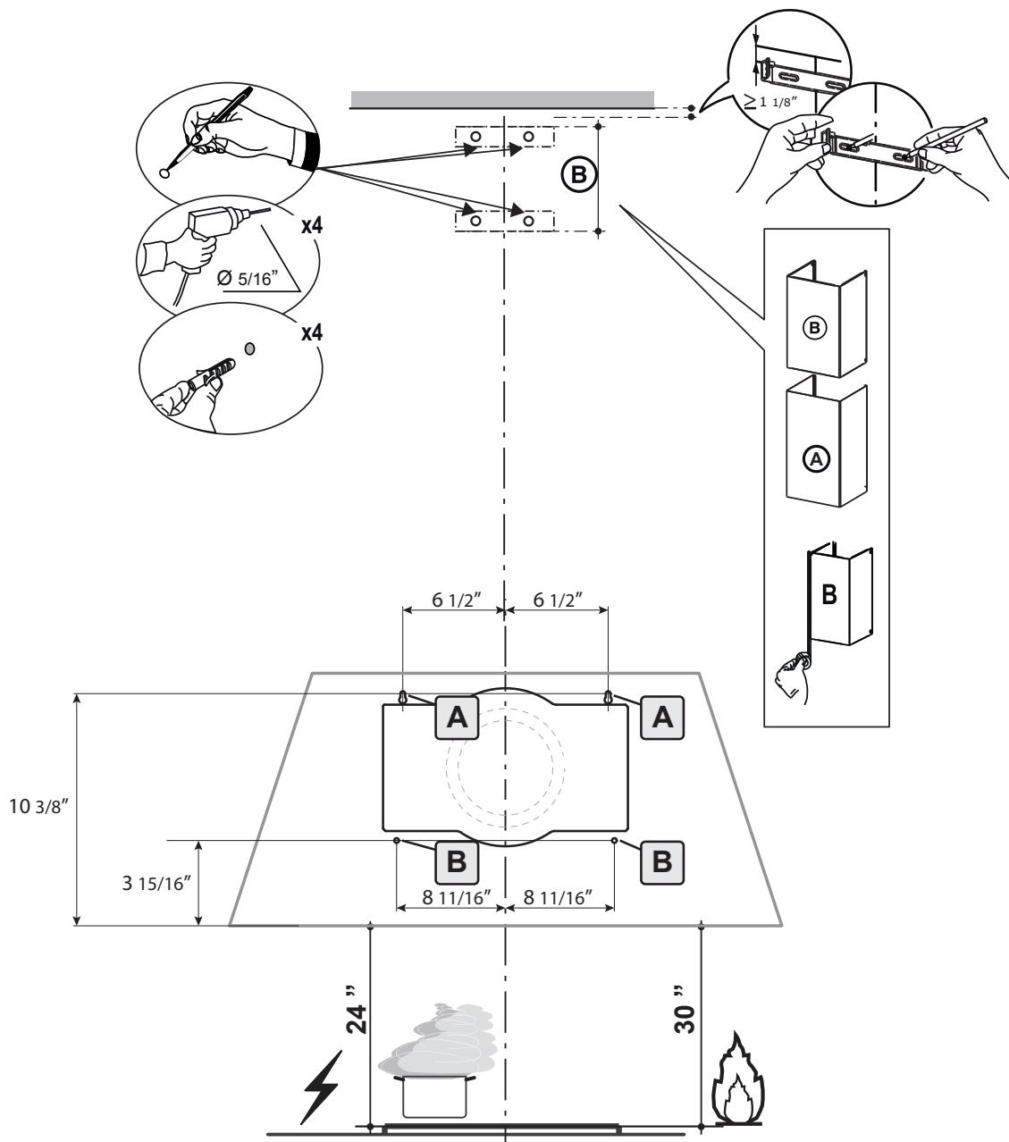
Marque la pared donde se indica (A),  $10 \frac{3}{8}"$  por encima de la línea horizontal y a una distancia de  $6 \frac{1}{2}"$  a la izquierda y derecha de la línea vertical. Comprobando que las dos marcas estén niveladas.
