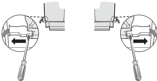
Depuis l'intérieur de la hotte, utilisez un tournevis à lame plate comme illustré pour débrancher les connecteurs de gauche et de droite du ventilateur.
