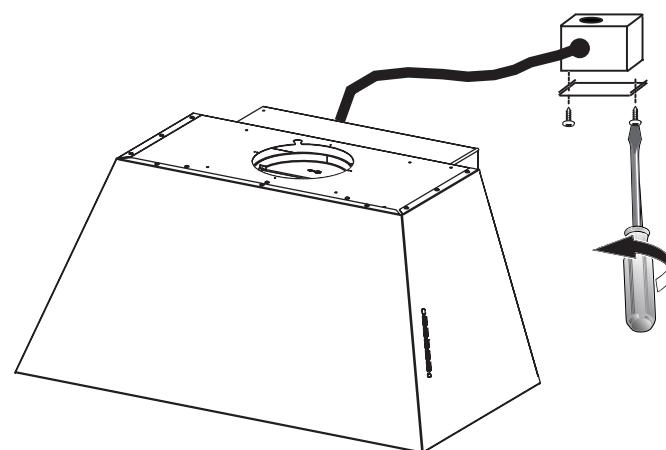
Tire del cable de suministro de energía a través del orificio para la conexión eléctrica a la caja de cableado.
