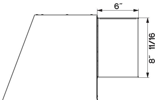
Raccordez le dispositif aux canalisations du plafond ou du mur.
