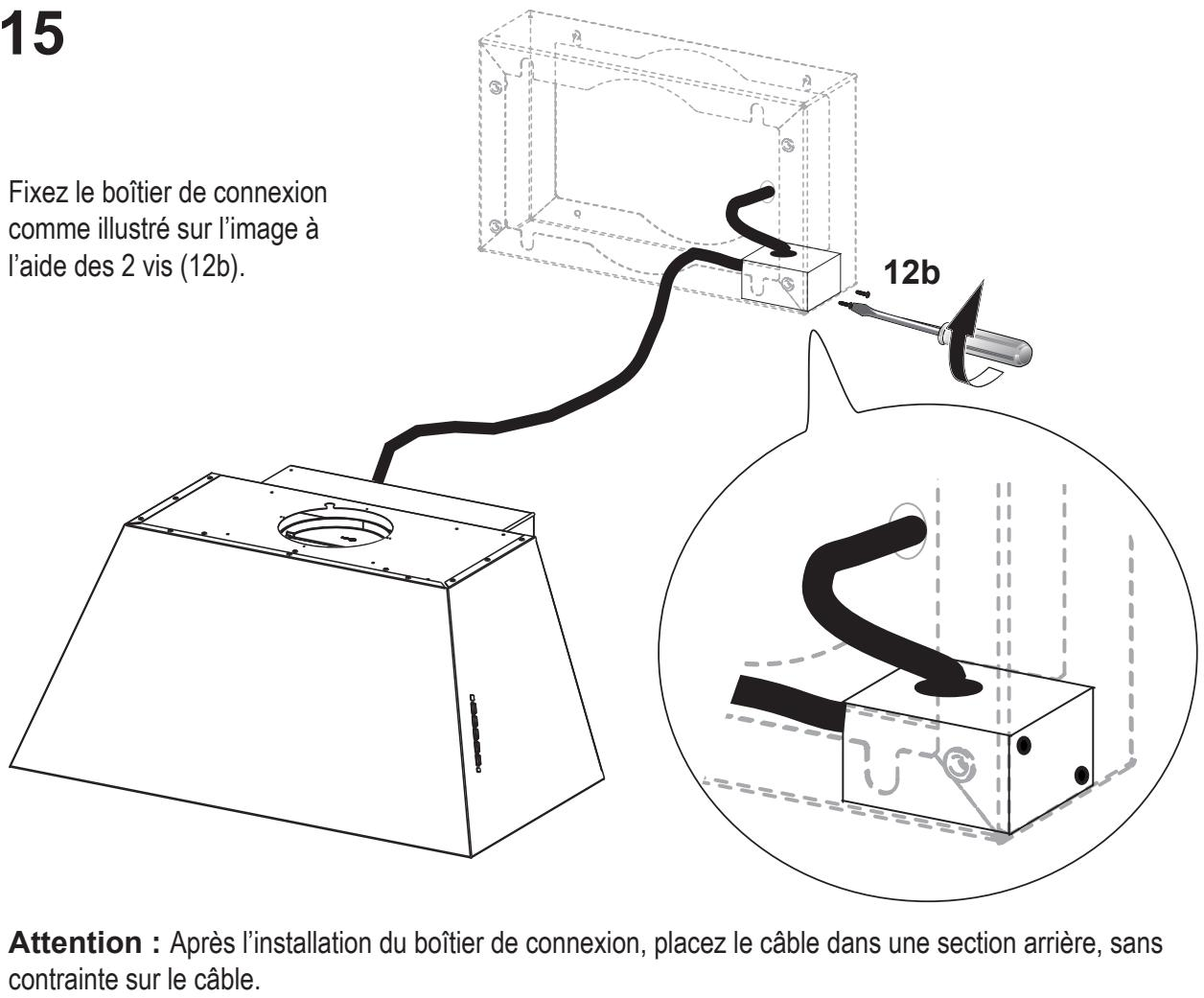
**Attention :** Après l'installation du boîtier de connexion, placez le câble dans une section arrière, sans contrainte sur le câble.
