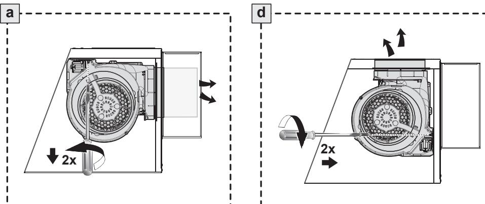
Después de retirar el ventilador, gire como se muestra hasta que esté en la posición correcta de ventilación trasera como se muestra en la Imagen b-c.
