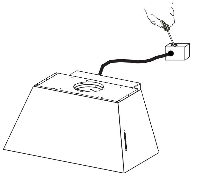
Retirez le couvercle du compartiment du boîtier de connexion en dévissant les deux vis.
