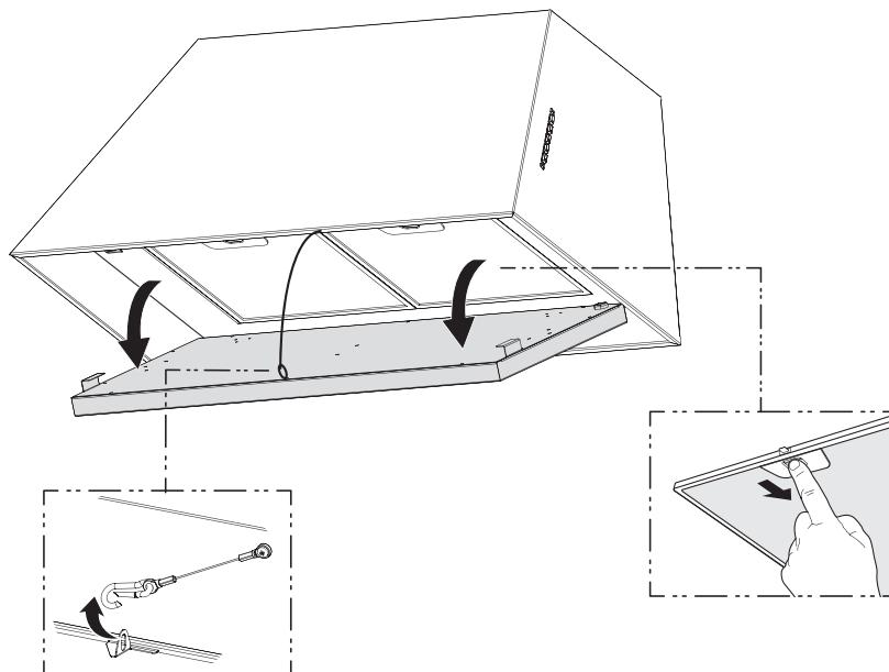
Abra el panel, desbloquee el cable de seguridad como se muestra. Quite los filtros empujando la palanca hacia la parte posterior de la unidad y al mismo tiempo tirando hacia abajo. No deseche los filtros y reserve para uso futuro.
